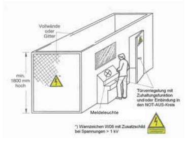
**Bild 4:** Prinzipskizze eines Prüfplatzes mit zwangläufigem Berührungsschutz in betretbarer Ausführung
