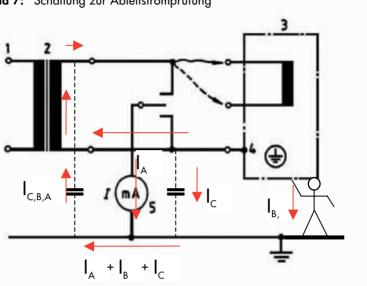
Bild 7: Schaltung zur Ableitstromprüfung
