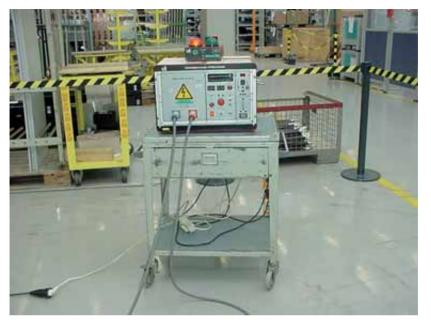
**Bild 5** Durch Ausziehband abgegrenzter Prüfbereich für einen Prüfplatz ohne zwangläufigen Berührungsschutz
