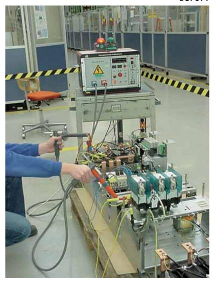
Bild 6 Prüfarbeiten unter Verwendung von Sicherheitsprüfspitzen
