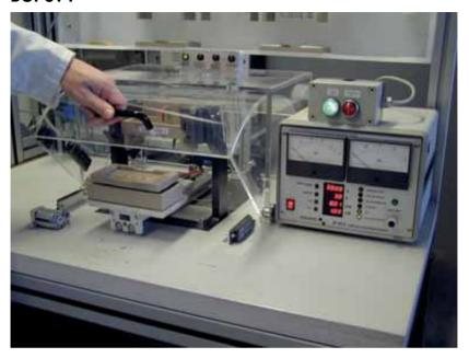
**Bild 3** Prüfplatz mit zwangläufigem Berührungsschutz, vollständiger Berührungsschutz durch Gehäuse mit beweglicher Verdeckung, elektromechanische Verriegelung mit Stellungsüberwachung (hier: Endschalter mit Personenschutzfunktion)
