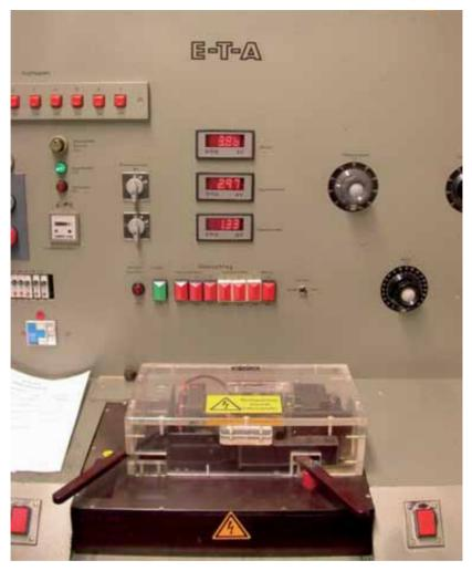
**Bild 4** Prüfplatz mit zwangläufigem Berührungsschutz, mechanische Verriegelung der Schutzhaube. Der Handhebel, der die Haube in Schutzstellung mechanisch verriegelt, ist mit Schaltkontakten belegt, die in den EIN- und AUS-Schaltvorgang integriert sind.
