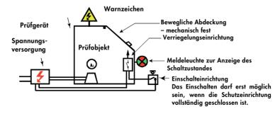
Bild 1: Prüfplatz mit zwangläufigem Berührungsschutz,
