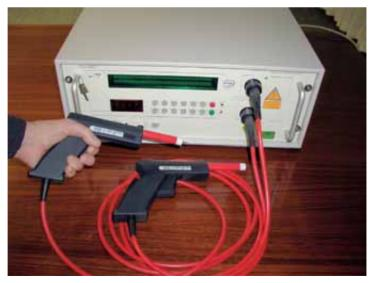
Bei Verwendung von Prüfeinrichtungen mit Sicherheitsprüfspitzen und Prüfspannungen über 1 kV muss die Hochspannungsseite der Prüfeinrichtungen galvanisch vom speisenden Netz getrennt und einschließlich der Prüfspitzen und deren Zuleitungen gegen Erde isoliert sein. Das Prüfobjekt muss gegen Erde isoliert sein, sofern dies durchführbar ist.
