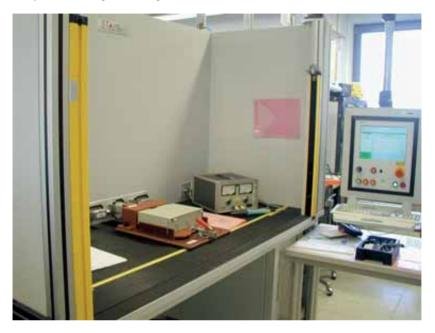
**Bild 1** Prüfplatz mit zwangläufigem Berührungsschutz durch Verwendung einer Sicherheitslichtschranke
