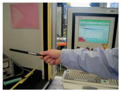
Bild 2 Funktionskontrolle der Sicherheitslichtschranke mittels Prüfstab
