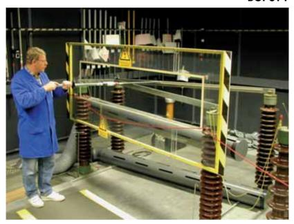
**Bild 8** Prüffeld, Wiederholungsprüfung an einem Spannungsprüfer, Abrolltest. Abgrenzung durch Seil und Polykarbonatscheibe, Absaugung (Ozon!)
