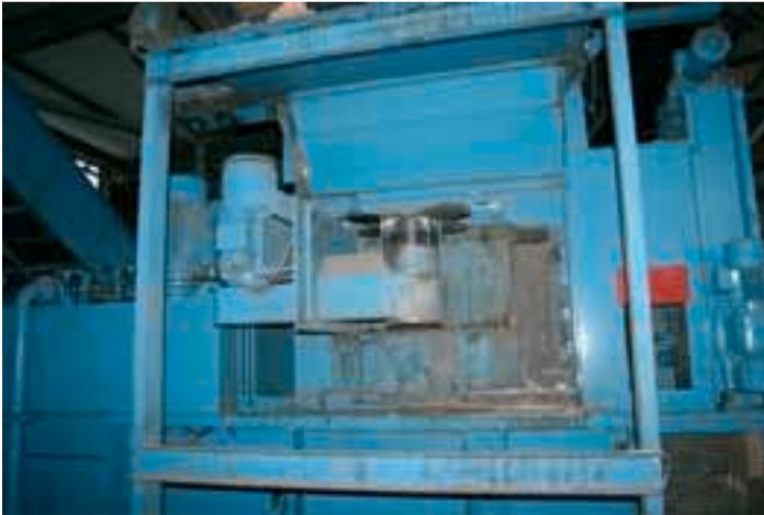
Bild 2: Ausgeschwenkte Verwirbelungseinrichtung
