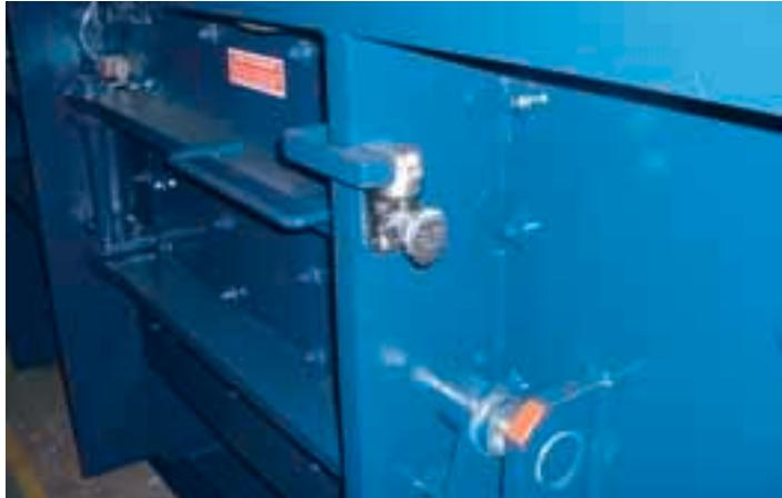
Bild 1: Zugangstür über Schloss gesichert; passender Schlüssel befindet sich im Schaltschrank, das Abziehen des Schlüssels vom Schaltschrank bewirkt die Trennung vom Netz
