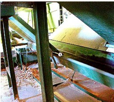
Abb. 1 Vibrorinne 1 Sicherheitsabstand von mindestens 25 mm zwischen Vibrorinne und trichterförmiger Verblechung
