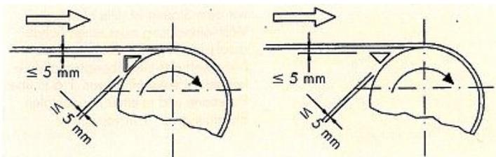
Abb. 2 Füllstücke an Einzugstellen von z.B. Förderbändern nach EN 619
