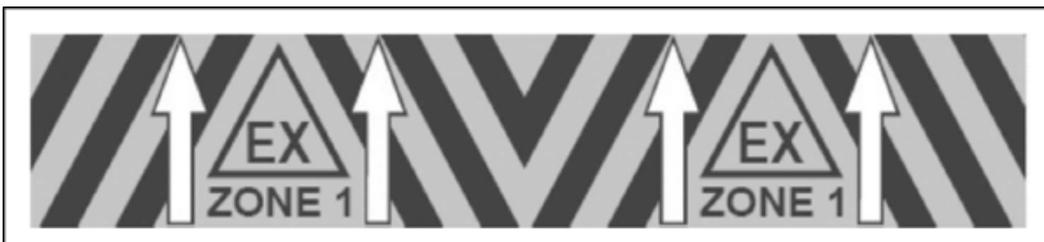
Abb. 2: Kennzeichnung der Ex-Bereiche auf dem Boden
