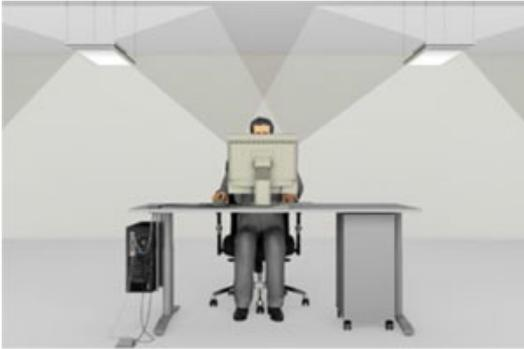
Abb. 46 Beispiel für Direkt-/Indirektbeleuchtung
