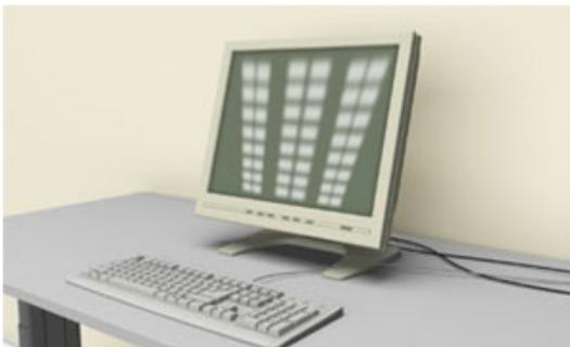
Abb. 42 Helle Flächen - zum Beispiel von Fenstern, Leuchten oder anderen Flächen mit hohen Leuchtdichten, die sich im Bildschirm spiegeln
