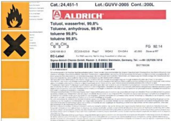
Bild 33: Bisherige Kennzeichnung von Gefahrstoffen nach EG-Stoff- bzw. Zubereitungsrichtlinie
