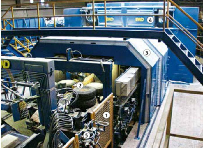
Bild 7: Einzugs- und Zentriereinrichtung vor dem Spanner
