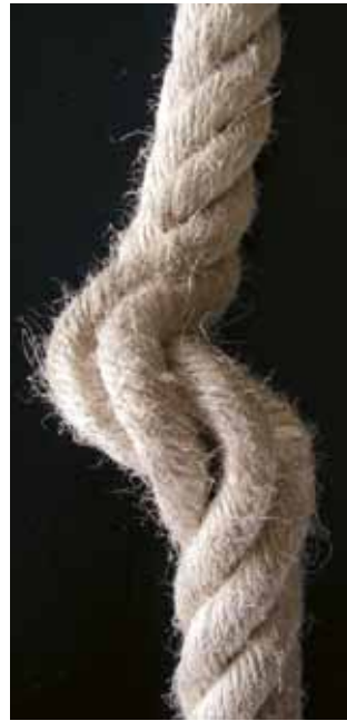
Bild 23-8: Durch Klanke zerstörter Litzenverbund
