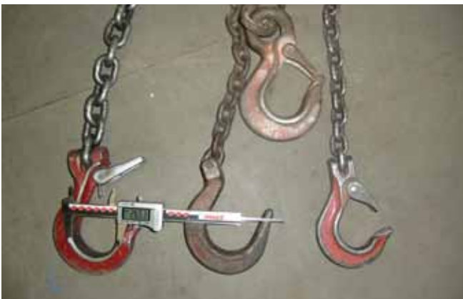
Bild 23-20: Die unteren drei Haken sind mehr als 10% geöffnet und damit ablegereif. 10% sind nicht viel! Aber trotzdem gefährlich!
