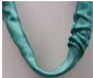
Bild 23-17: Verformung durch Wärme
