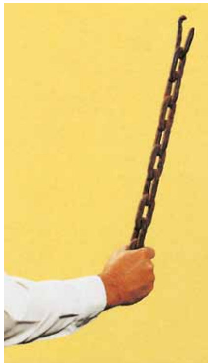
Bild 23-11: Durch Überlastung steif gezogene Kette
