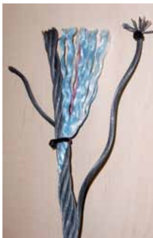
Bild 8-2: Aufbau eines Litzenseiles
