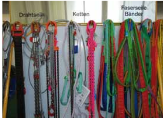
Bild 24-1: Vorbildliche Aufbewahrung von Seilen und Ketten
