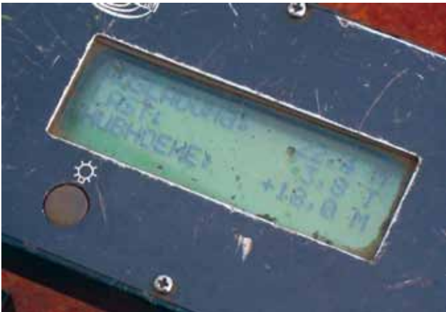
Bild 5-3: Steuerbirne mit digitaler Lastanzeige
