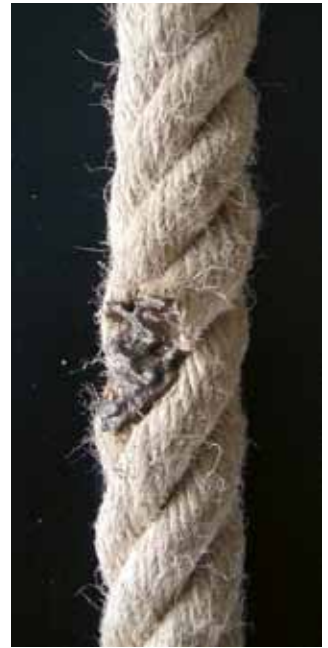
Bild 23-9: Wärmeeinfluss hat eine Litze zerstört
