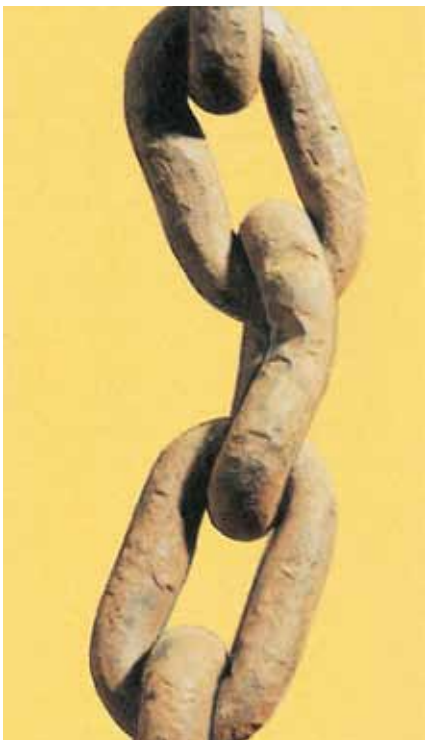
Bild 23-10: Kette mit verbogenem und eingekerbtem Kettenglied
