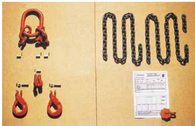
Bild 11-4: Aus diesen Bestandteilen entsteht eine Anschlagkette im Baukastensystem
