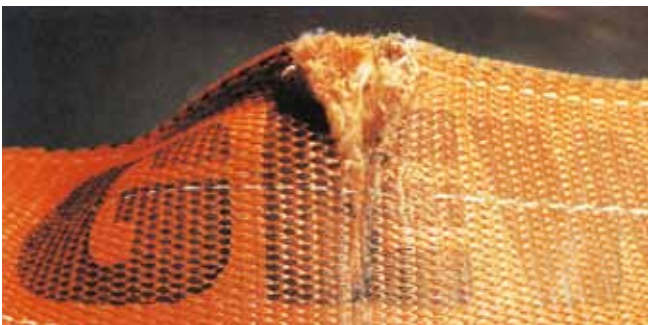
Bild 23-14: Durch scharfkantige Last eingeschnittenes Hebebänder
