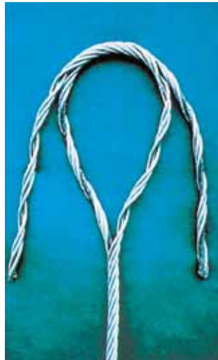
Bild 9-6: Die beiden Enden mit den drei Litzen sind in der Mitte zusammengebogen. Von hier aus beginnt das Verseilen
