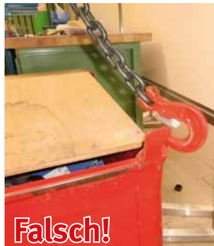
Bild 16-4: Haken rutschen bei Schlaffketten aus den Ösen
