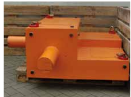
Bild 5-5: ...sieht man die einseitige Belastung nicht an!
