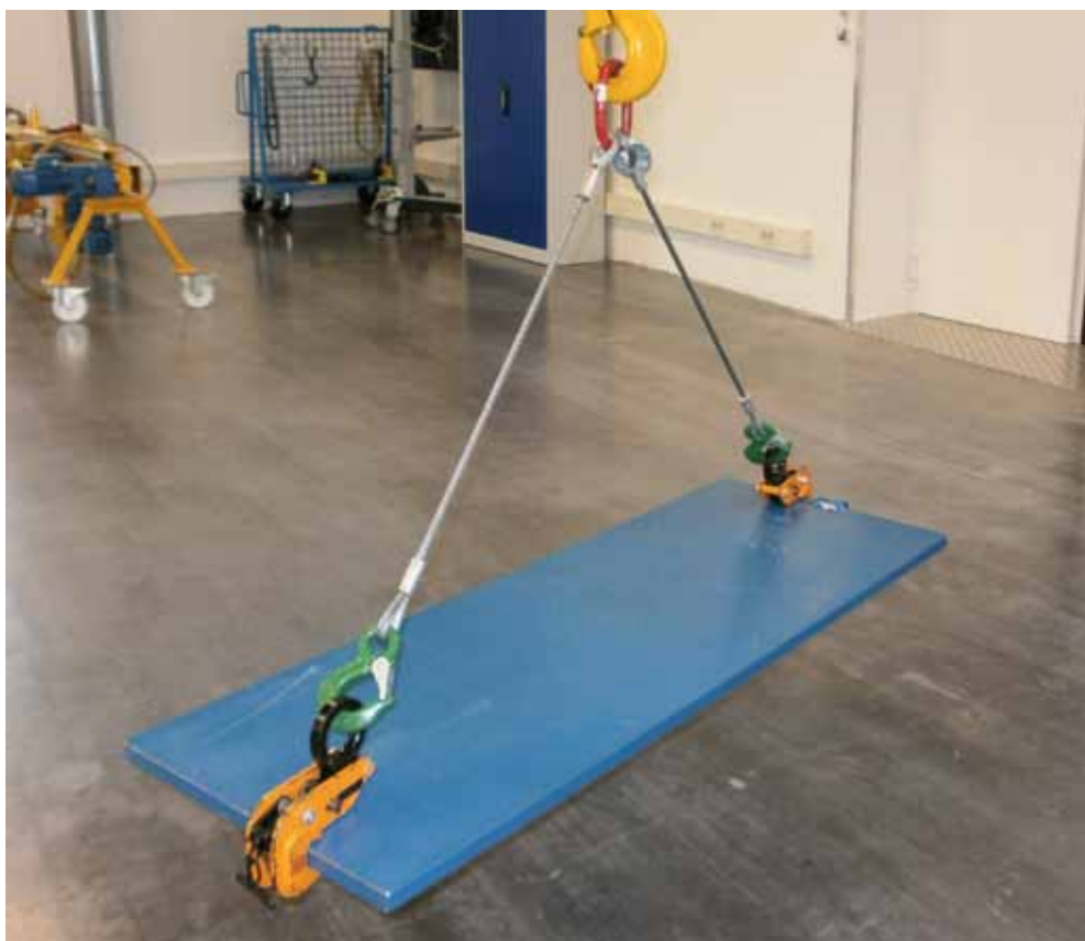
Bild 13-1: Blech horizontal sicher transportiert
