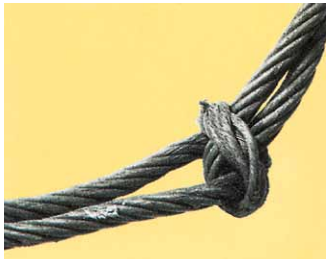
Bild 9-2: Unzulässiger Knoten zerstört den Seilverbund
