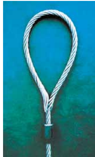
Bild 9-7: Die beiden Enden sind gegeneinander verseilt
