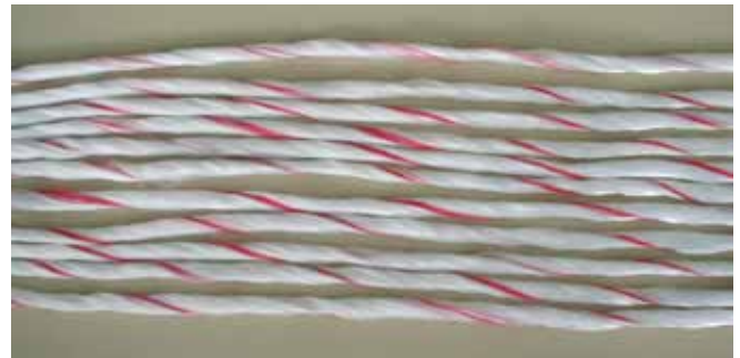
Bild 23-19: Die Einlage einer Rundschlinge besteht meist aus einer einzelnen Kardeele, die mindestens 11-mal umläuft. Wird diese nur einmal durchgeschnitten, ist der innere Verbund der Rundschlinge durch Reibung nicht mehr gegeben!
