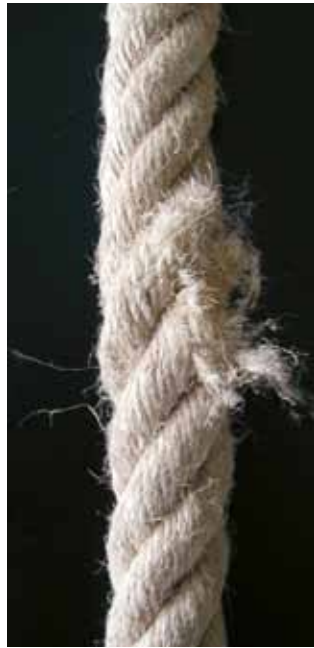
Bild 23-7: Zerstörung einer Litze
