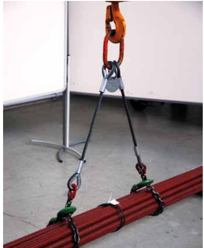
Bild 6-1: Kombination Seil/Kette zur Schonung der Drahtseile
