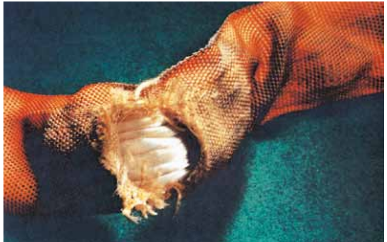
Bild 23-16: Durch Wärmeeinfluss zerstörte Ummantelung
