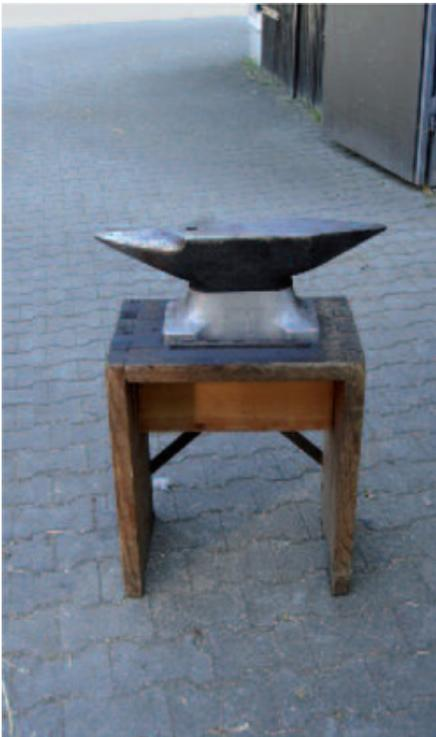
**Bild 4-2: Amboss mit schwingungsdämpfender Zwischenlage (Untergestell)**
