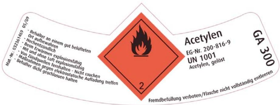
Abb. 10 Etikett für eine Gasflasche nach Transportrecht und Stoffrichtlinie \*
