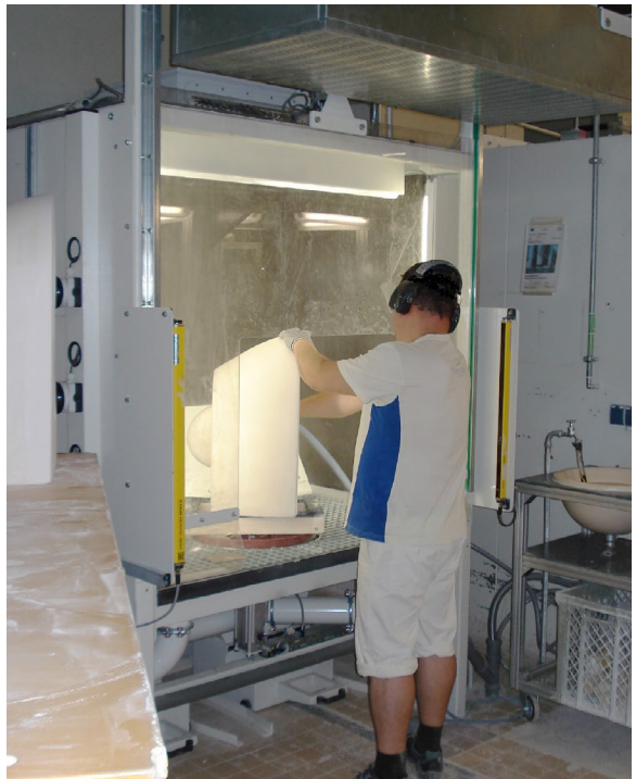
Abb. 22 Für das Abblasen von Staub wird automatisch eine Schutzhaube mit Arbeitsöffnung abgesenkt
