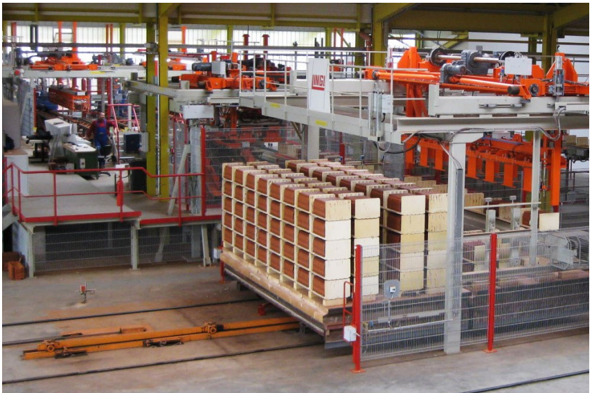
Abb. 8 Setzanlage für Ziegelprodukte
