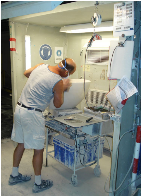
Abb. 10 Weißputz von Sanitärartikeln
