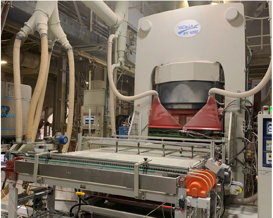
Abb. 20 Fliesenpresse mit Absaugung und Erfassungseinrichtungen
