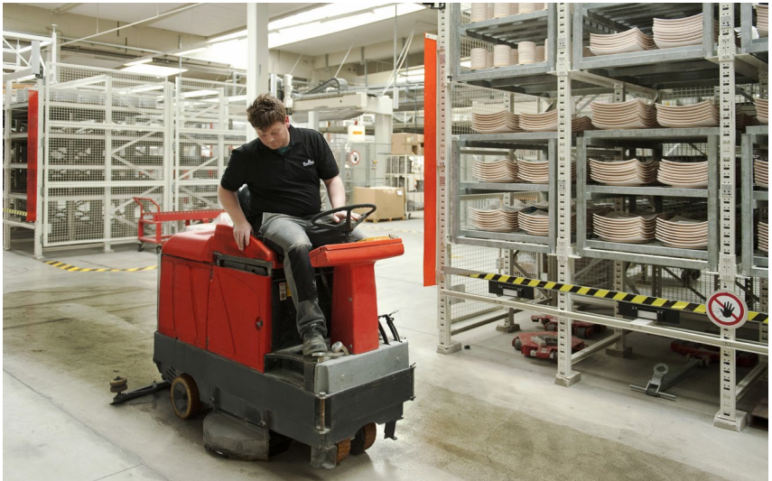
Abb. 15 Feuchte Bodenreinigung mit Scheuersaugmaschine
