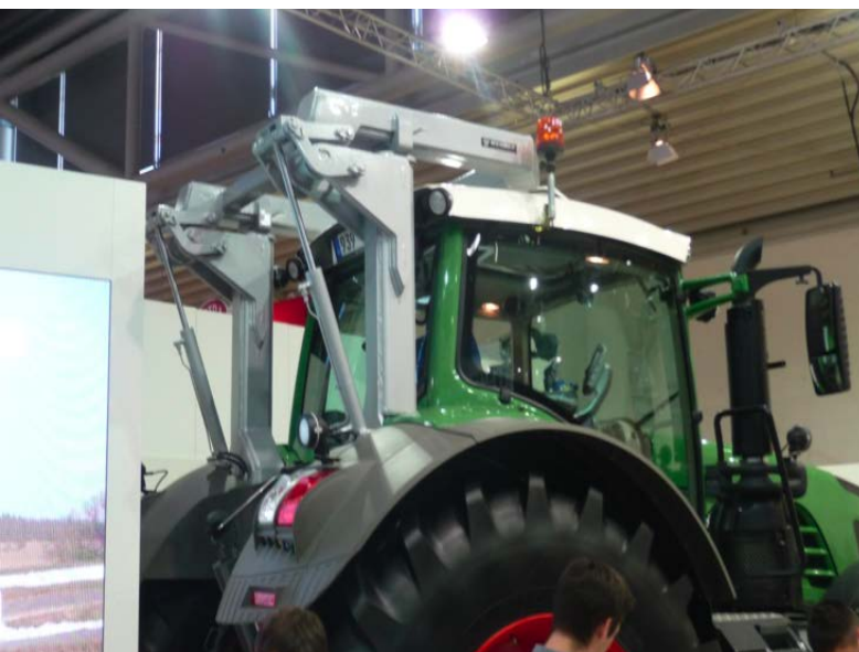
Abb. 3 Vom Hersteller angebotener zusätzlicher Überrollschutz (ROPS)
