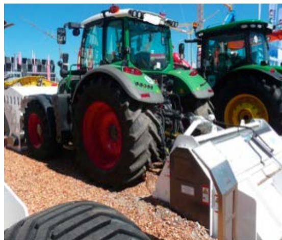
Abb. 2 Traktor mit Ballastierung und getragenen Anbaugerät
