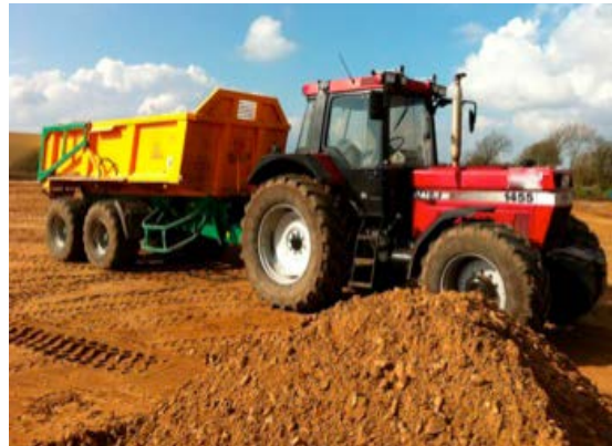
Abb. 1 Traktor mit angehängter knickgelenkter Mulde
