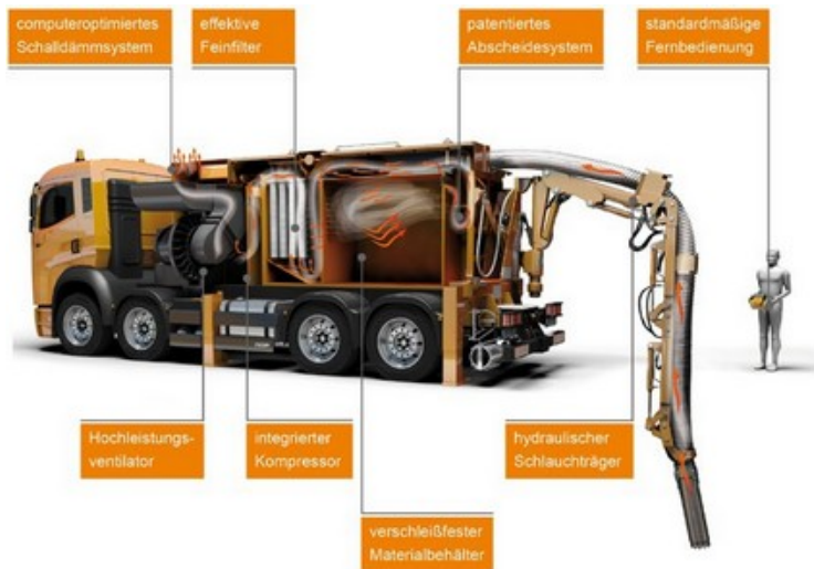
Abb. 10 Bestandteile eines Saugbaggers
