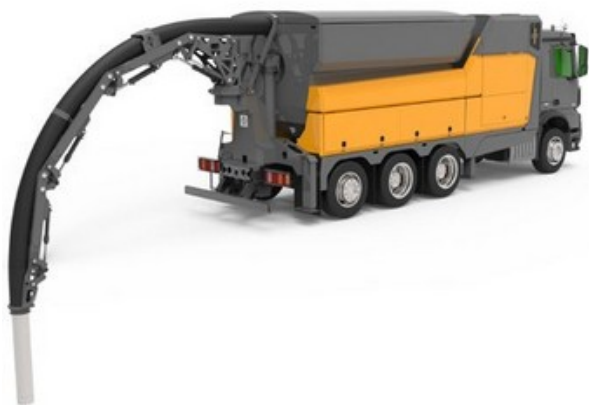
Abb. 11 Saugbagger großer Leistung auf LKW-Fahrgestell
