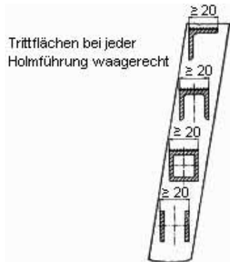
Beispiel von rutschhemmenden Sprossenquerschnitten mit einer Auftrittstiefe von mindestens 20 mm
