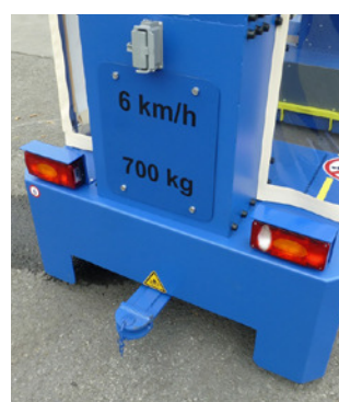
Abb. 24 Rückleuchte für Routenzüge
