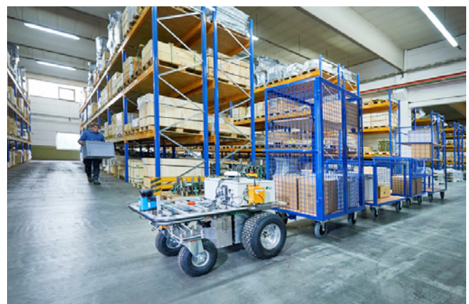
Abb. 4 Routenzug mit FTS und Regalwagen
