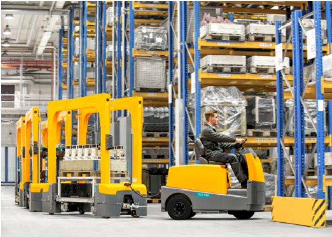
Abb. 9 Transport von Großladungsträgern (GLT) mit dem Routenzug in die Produktion
