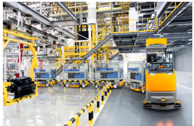
Abb. 5 Produktionsversorgung mit einem fahrerlosen Routenzug
