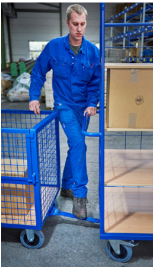
Abb. 22 Quetschgefahr beim Ankoppeln von Routenzügen
