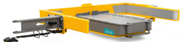
Abb. 23 Elektrisch verbundener E-Frame-Anhänger
