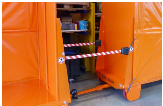
Abb. 25 Durchtrittsicherung bei Routenzügen
