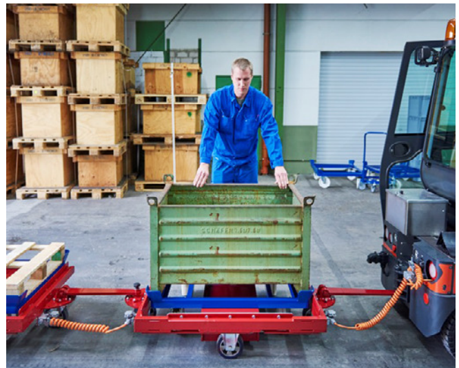
Abb. 20 Einschieben von Bodenroller in den Routenzug
