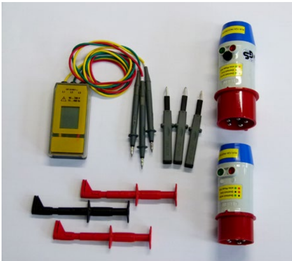
Abb. 42 Drehfeldprüfgerät, Prüfspitzen und Prüfadapter für Drehstrom- Anschlüsse
