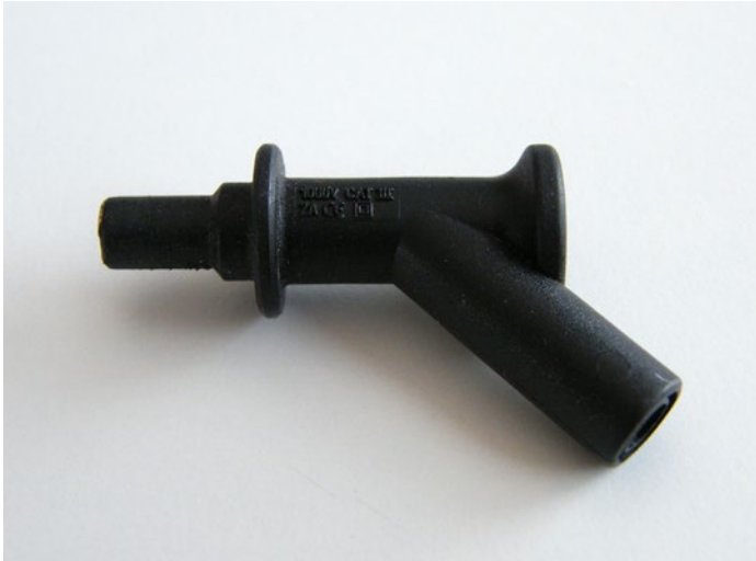
Abb. 43 Magnetische Prüfspitze (selbsthaftend)
