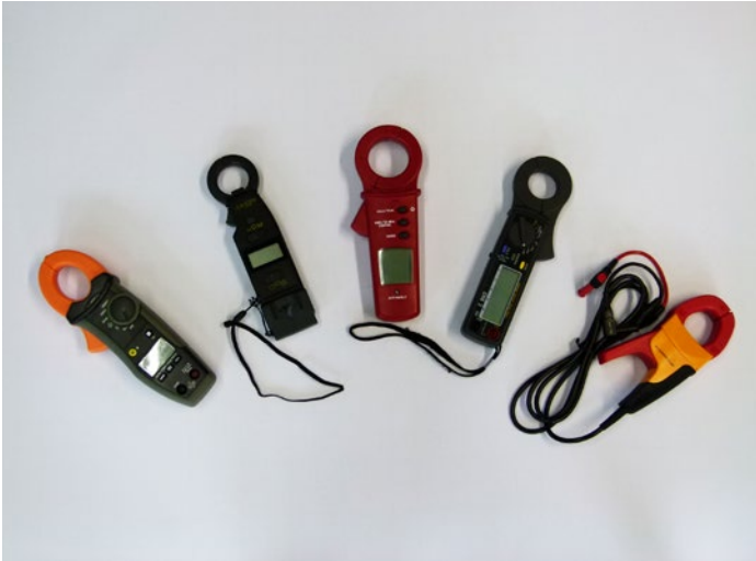
Abb. 39 Strommesszangen („Zangenampere-meter“); Einzelgeräte und Adapter
