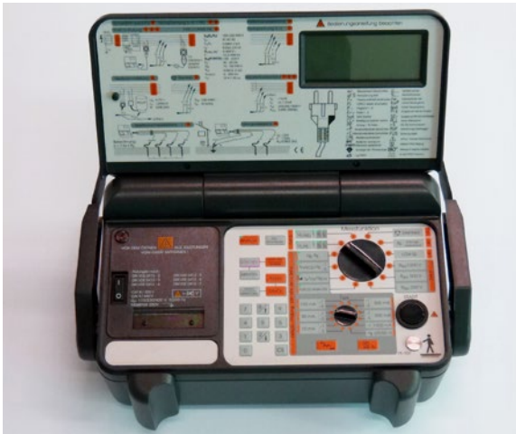
Abb. 33 Prüfgerät für Messungen an elektrischen Anlagen und Betriebsmitteln, zusätzlich: integrierter Drucker, Gehäuseschutzart IP 54
