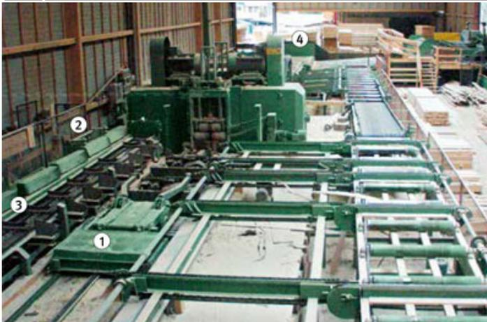
Bild 21: Doppelwellenkreissäge mit Modelrücklauf
