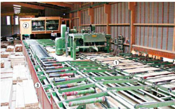
Bild 22: Doppelwellenkreissäge mit Modelrücklauf
