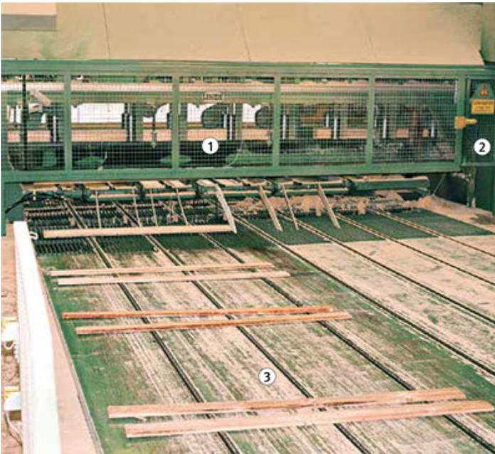
Bild 36: Ausführungsbeispiel Stetigförderer für Seitenwarenabtransport, um den Zugang zum Gefahrenbereich der Mehrblattkreissäge zu verhindern
