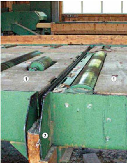
Bild 34: Querförderer als Winkelübergabe im Abzugsrollengang (untere Endstellung)
