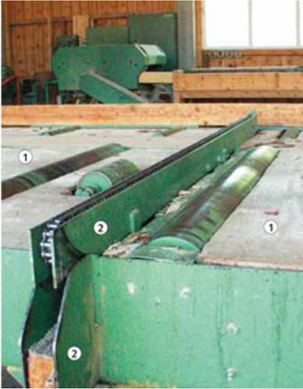
Bild 33: Querförderer als Winkelübergabe im Abzugsrollengang (obere Endstellung)
