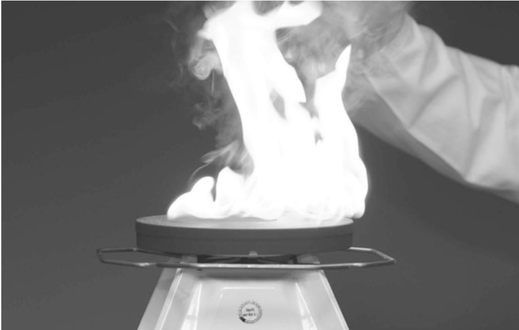
Abb. 1: Entzündung brennbarer Flüssigkeiten auf heißer Oberfläche
