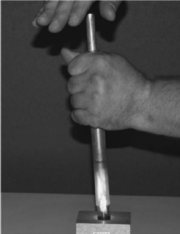
Abb. 12: Entzündung eines Wattebausches durch adiabatische Kompression
