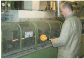
**Bild 6-2: Mit Schutzgitter:  $B = 2,3 \mu\text{T}$ ; der zulässige Wert und die anderen sicherheitstechnischen Anforderungen werden eingehalten**
