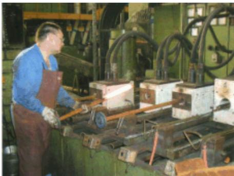
**Bild 5-5: Induktive Vorwärmeinrichtung**
