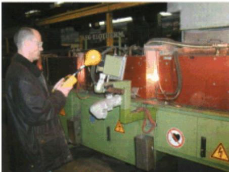
**Bild 5-3: Messungen an einem induktiven Durchlaufofen eines Warmformbetriebes**
