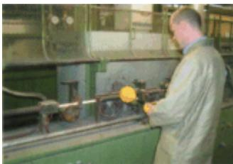
**Bild 6-1:** Ohne Schutzgitter:  $B = 6,3 \mu\text{T}$ ; für kleinere Abstände wird der Wert für den "Gefahrbereich" überschritten, außerdem sind Gefahrstellen zugänglich
