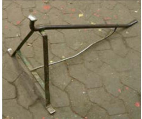
Abb. 2-5 Weniger geeigneter Hufbeschlagbock
