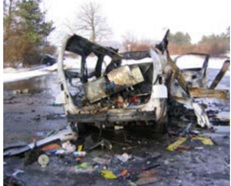
Abb. 9-1 Fahrzeug nach Druckgasflaschenexplosion
