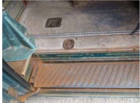
Abb. 9-2 Belüftungsöffnung im Fahrzeugboden
