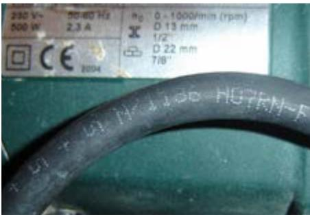
Abb. 5-2 Gummischlauchleitung
