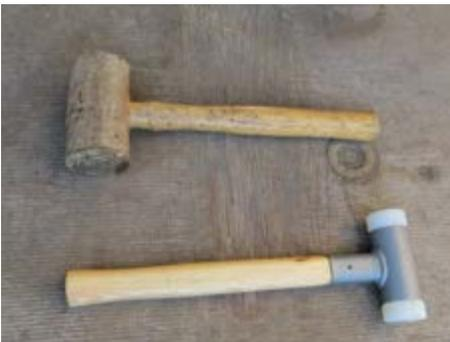
Abb. 2-1 Lederhammer und rückschlagfreier Hammer
