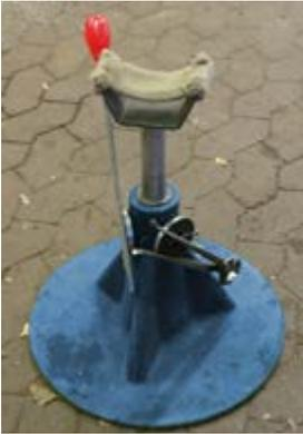
Abb. 2-4 Gut geeigneter Hufbeschlagbock
