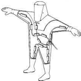
Abb. 8-2: Beispiel einer Luftspülung im Anzug zur Klimatisierung
