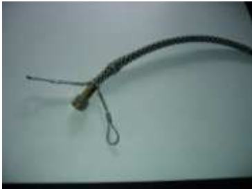
Abb. 3-7: Metallstrumpf als Schlauchsicherung gegen Umherschlagen bei Abriss. Weitere Möglichkeiten sind Festlegen, Umhüllen und ausreißsichere Schraubkupplungen, die nur mittels Werkzeug gelöst werden können.
