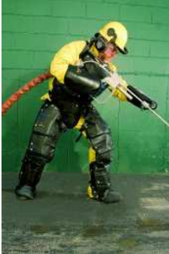
Abb. 3-11: Als modulare "Rüstung" ausgeführte Schutzbekleidung gegen Verletzungen durch Hochdruckwasserstrahl, über oder unter Regenschutzkleidung zu tragen.
