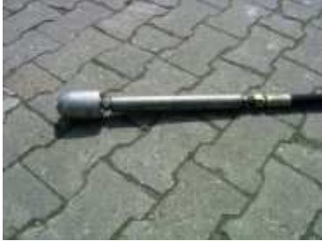
Abb. 3-9: Schutz gegen unbeabsichtigte Schlauchumkehr durch Verwendung eines starren Übergangsstückes zwischen HD-Schlauch und Düse
