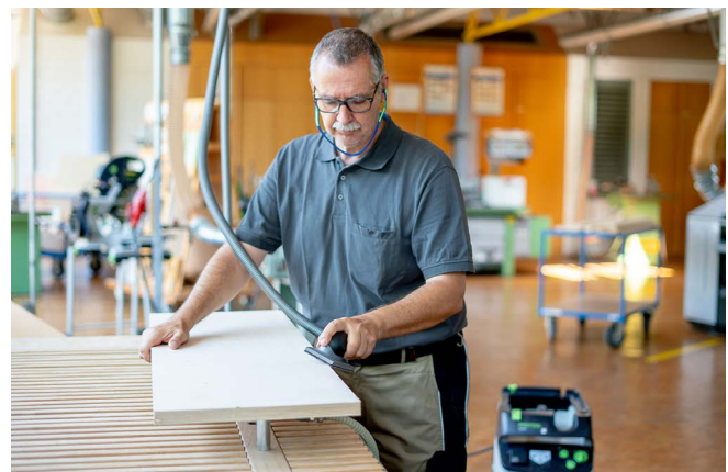
Abb. 12.6 Tischler bearbeitet Werkstück mit einem abgesaugten Handschleifklotz
