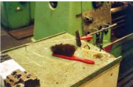
Bild 2-26: Schutzausrüstung am Drehmaschinenarbeitsplatz
