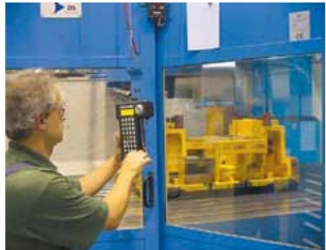
Bild 2-36: Großes Bearbeitungszentrum; unzureichende Sicht von außerhalb auf die Spindel bzw. die Fräsbahn des Fräsers. In vielen Fällen kann eine Fernsehkamera eine ausreichende Bildinformation von Spindel und Fräsbahn auf einen Bildschirm nach außen übertragen, sodass ein Betreten des Gefahrenbereichs der Maschine bei laufendem Betrieb nicht notwendig ist
