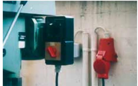
Bild 2-20: Kleinere Maschine mit Anschluss über Steckvorrichtung und Not-Aus integriert im Ein-Aus-Schalter
