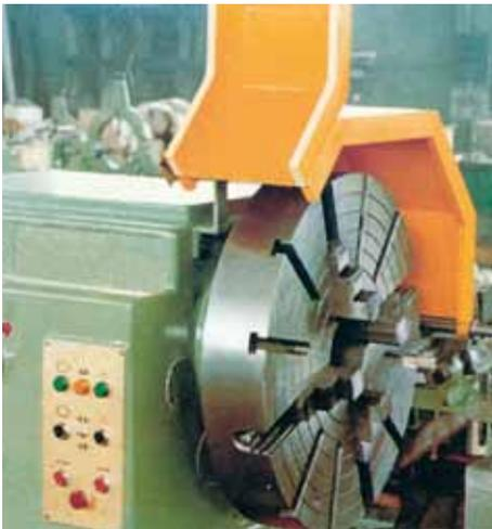
Bild 1-9: Futterschutzhaube an einer konventionellen Drehmaschine, Beispiel 1
