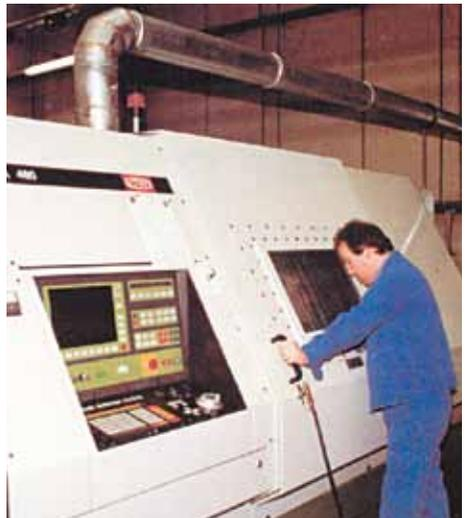
Bild 4-1: Absaugung an einer CNC-Drehmaschine
