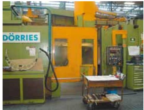
Bild 2-45: Große Vertikal-Drehmaschine (Karussellmaschine), geschlossene Maschine
