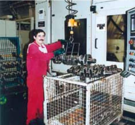
Bild 5-4: Kurbelwellenbeladung mittels Hebehilfe
