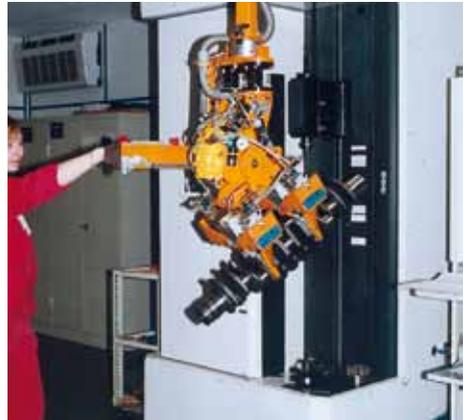
Bild 5-5: Positionierung der Kurbelwelle mittels Balancer
