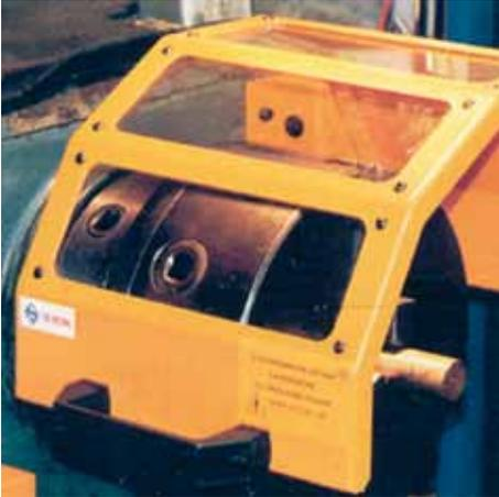
Bild 1-11: Futterschutzhaube an einer konventionellen Drehmaschine, Beispiel 3
