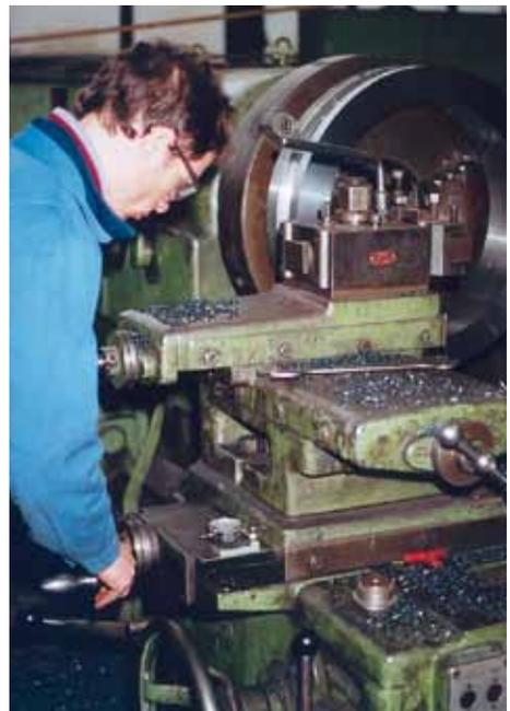
Bild 2-4: Gefährdung durch wegfliegende Späne beim Drehen
