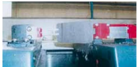
Bild 9-7: Manipulation des Positionsschalters
