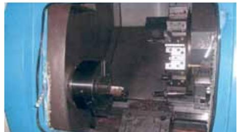
Bild 9-10: Unfallmaschine mit durchschlagener Sichtscheibe
