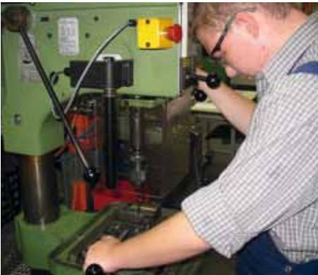
Bild 2-23: Bewegliche Verdeckung an einer Bohrmaschine
