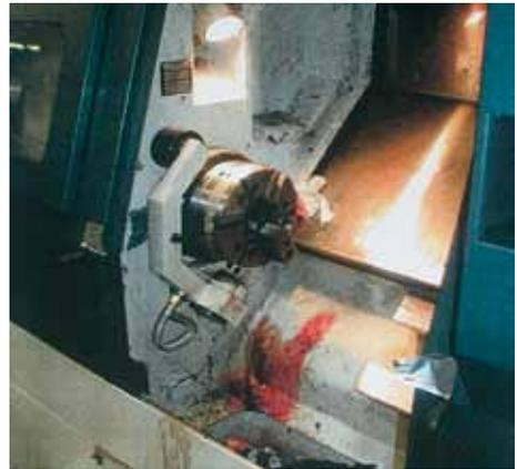
Bild 9-6: „Offener“ Arbeitsraum CNC-Drehmaschine
