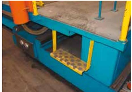
Bild 2-55: Sicherer Aufstieg auf Bedienstand einer Horizontal-Drehmaschine
