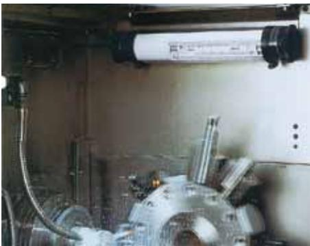
Bild 5-3: Maschinenschutzrohrleuchten in Werkzeugmaschinen
