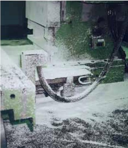
Bild 2-3: Gefährdung durch Ausrutschen
