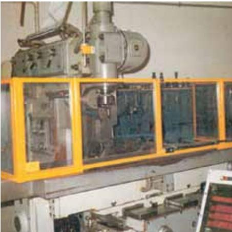
Bild 1-12: Verdeckung an einer konventionellen Fräsmaschine, Beispiel 1
