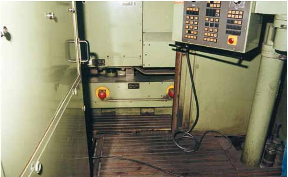
Bild 2-16: Zusätzliche Not-Aus-Schalter im Fußbereich an einem Bearbeitungszentrum
