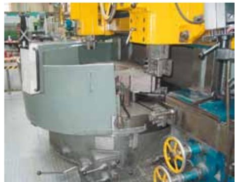
Bild 2-50: Vertikal-Drehmaschine mit trennender Schutzeinrichtung (Schiebemechanismus)
