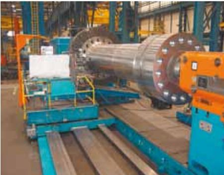
Bild 2-44: Große Horizontal-Drehmaschine
