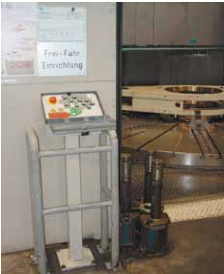
Bild 2-39: Freifahrereinrichtung mit sinnfälliger Kennzeichnung der Achsbewegungen über eigene Tiptaster
