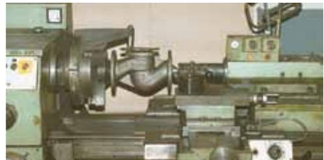
Bild 9-1: Drehmaschine mit sicherheitswidriger Spanneinrichtung, *Beispiel 1*
