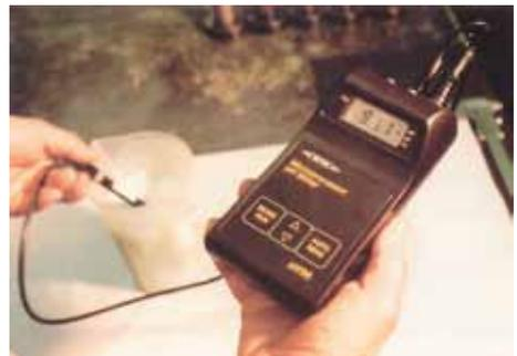
Bild 4-6: Einsatz eines pH-Meters
