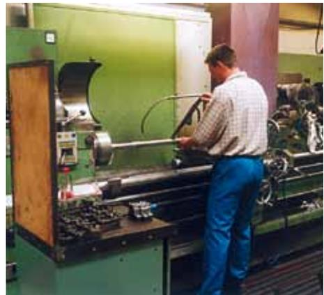
Bild 2-21: Gefahr des Erfasstwerdens an glatten, rundlaufenden Wellen
