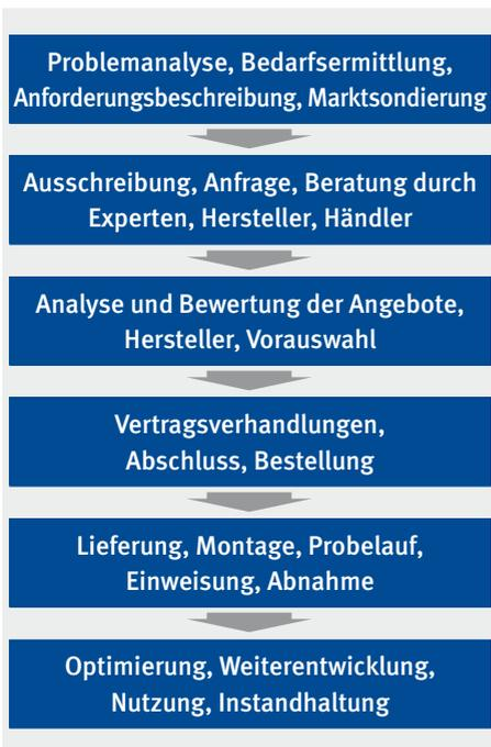
Bild 1-7: Projektablauf bei der Auswahl von Maschinen
