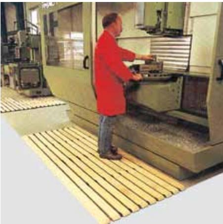
Bild 5-1: Sicherheits-Holzlaufrost
