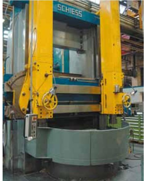
Bild 2-49: Vertikal-Drehmaschine (ältere Bauart) mit trennender Schutzeinrichtung
