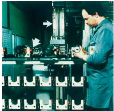
Bild 2-41: Räumliche Trennung in Werkzeugwechselstation durch Werkzeugregal
