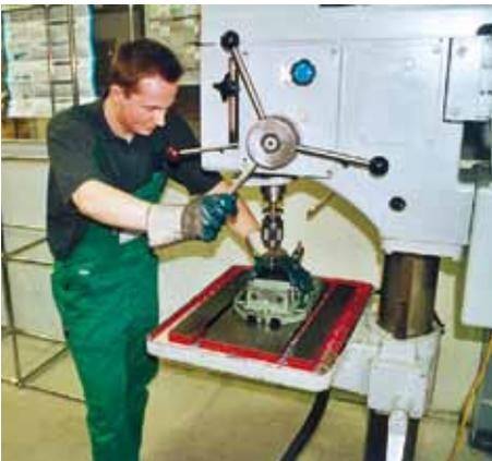
Bild 2-22: Verbotswidriges Arbeiten mit Handschuhen (nachgestellt)
