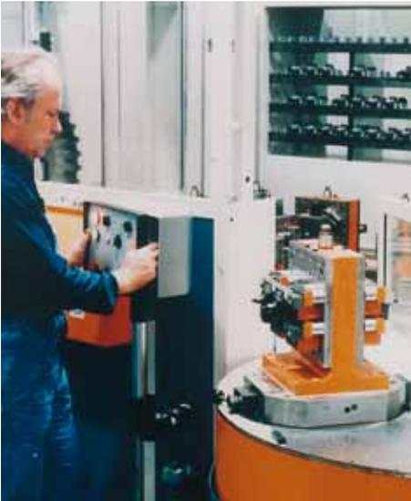
Bild 2-32: Auslösung eines Materialtransportes durch ortsbindende Zweihandbedienung
