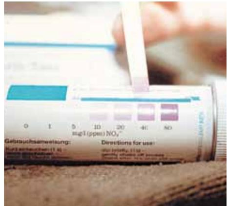
Bild 4-5: Prüfung des Nitritgehaltes durch Farbvergleich
