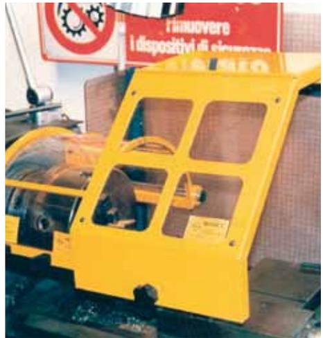
Bild 1-10: Futterschutzhaube an einer konventionellen Drehmaschine, Beispiel 2
