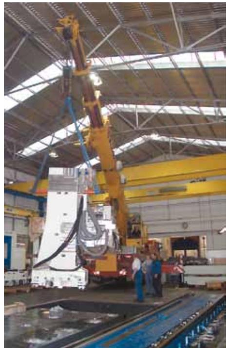
Bild 2-9: Maschine im Autokran
