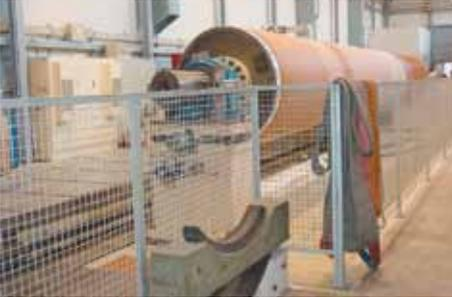
Bild 2-51: Horizontal-Drehmaschine mit rückwärtiger Umzäunung (mindestens 1,4 m hoch)
