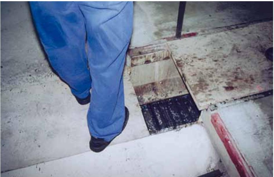
Bild 2-58: Unvollständig abgedeckter Späneförderer
