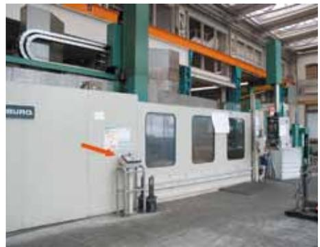
Bild 2-38: Große eingehauste Vertikal-Drehmaschine mit Freifahrereinrichtung
