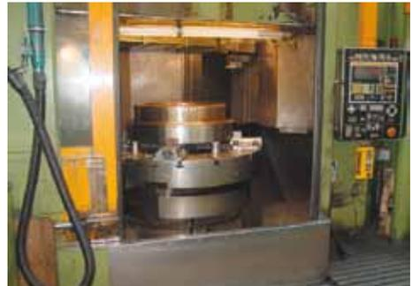
Bild 2-46: Große Vertikal-Drehmaschine (Karussellmaschine), geöffnete Maschine
