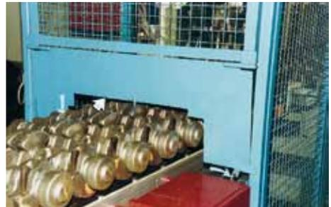
Bild 2-30: Einlaufschutz am formschlüssigen Transportsystem mit hoher Zugkraft
