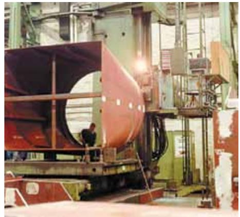
Bild 2-43: Innenrundbearbeitung auf einem großen Ständerbohr- und Fräswerk
