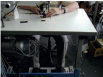
**Abb. 29:** Erweiterter Beinfreiraum; Sitzposition mittig unter der Nadel
