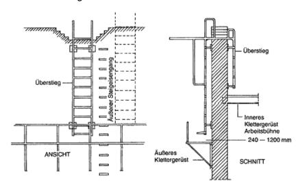
Bild 2: Beispiel einer Steigleiter zum Übersteigen der Mauerkrone
