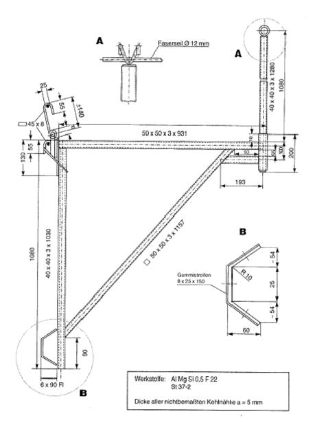
Bild 4: Konsolen aus Aluminium
