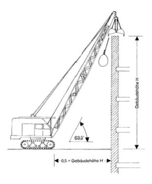
Bild 6: Abgreifen bzw. Arbeiten mit der Fallbirne
