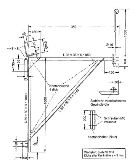
Bild 3: Konsolen aus Stahl
