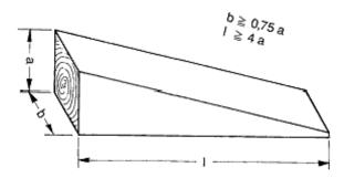
Bild 5: Spannkeil aus Holz
