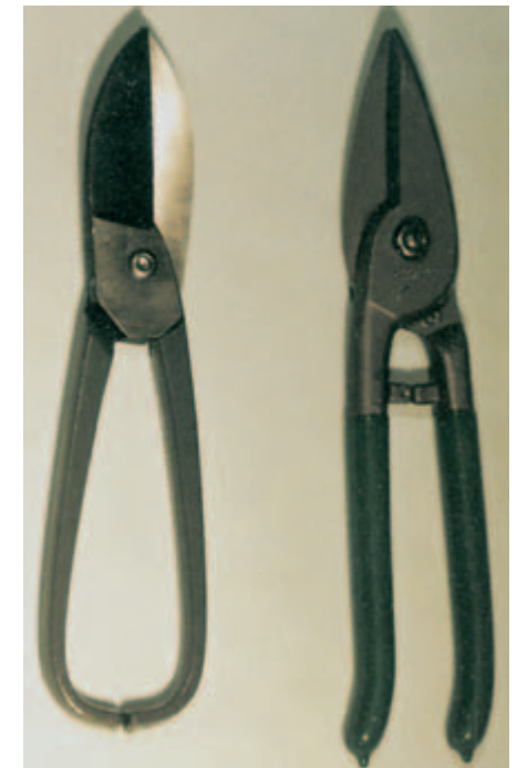
Bild 9-1: Links – nicht zulässige Blechschere mit Quetschstelle zwischen den Handgriffenden Rechts – Blechschere mit Distanz- haltern außerhalb der Griffe und offenen Griffenden
