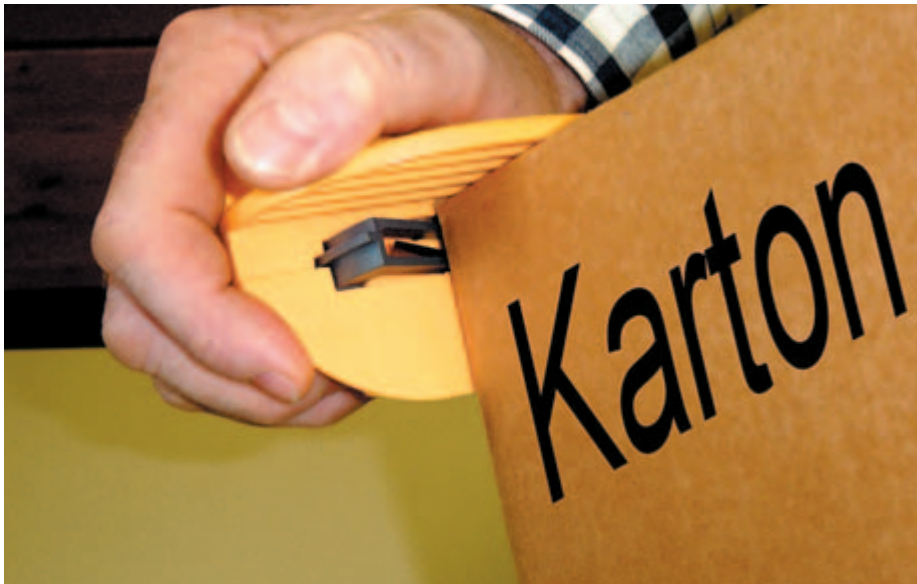
Bild 12-4: Messer mit beweglichem Schutzkragen als Klingenschutz
