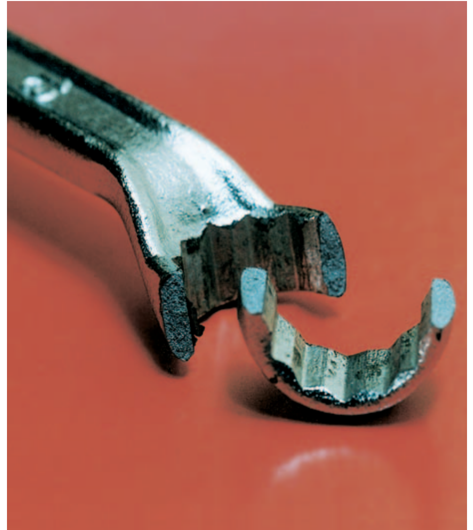
Bild 7-10: Handwerkszeuge, an denen größere Körperkräfte eingesetzt werden, sollten immer von hoher Qualität sein. Ein Bruch durch mangelhafte Qualität, wie an diesem Ringschlüssel, kann durch plötzlich auftretende Gewichtsverlagerung oder unkontrolliertes Freiwerden einer angespannten Armbewegung zu schmerzhaften Verletzungen führen
