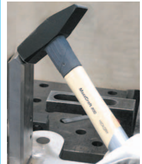
Bild 2-11: Entprellter Schlosserhammer mit Stielschutzhülse im Gummimantel
