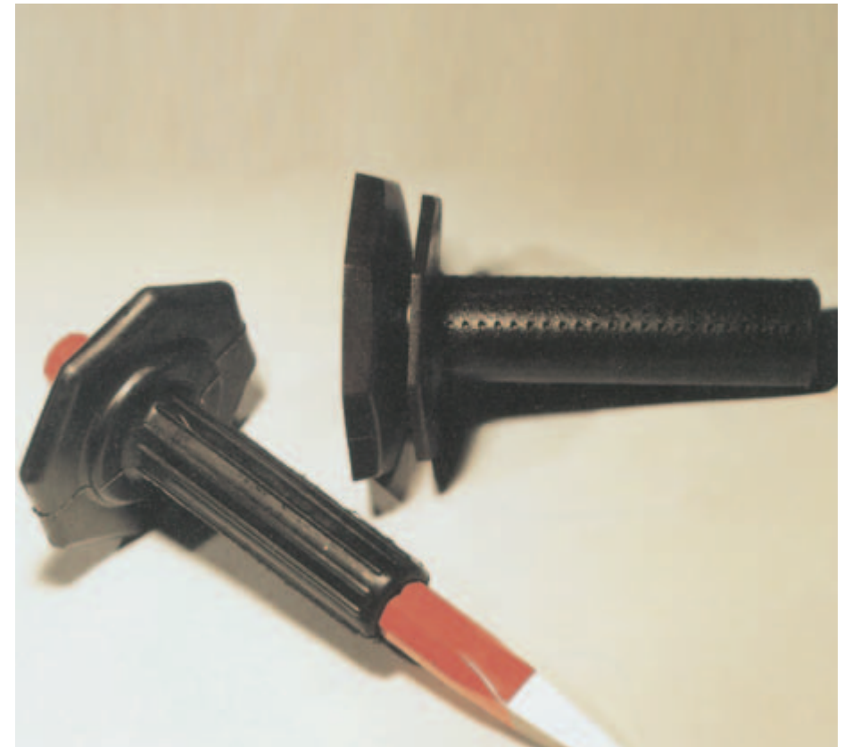
Bild 3-3: Links – aufgeklebter, abrollsicherer Handschutz mit Meißel, stärkeren Verformungen bei Fehlschlägen im Bereich der Finger wird durch dickere Tellerwandung im Innenbereich begegnet Rechts – aufklebbarer Handschutz für Meißel mit erhöhtem Schutz der Finger bei Fehlschlägen durch Abstand mittels zweitem Teller
