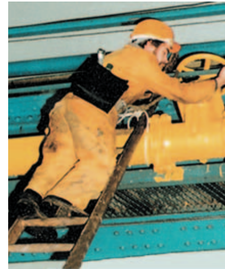
Bild 1-6: Bei Arbeiten in Höhen, z. B. auf Leitern, Laufstegen, Gerüsten o. Ä., erleichtert die Werkzeugtasche den Transport der Werkzeuge beim Auf- und Absteigen; an hoch gelegenen Arbeitsplätzen dient sie als Werkzeugablage
