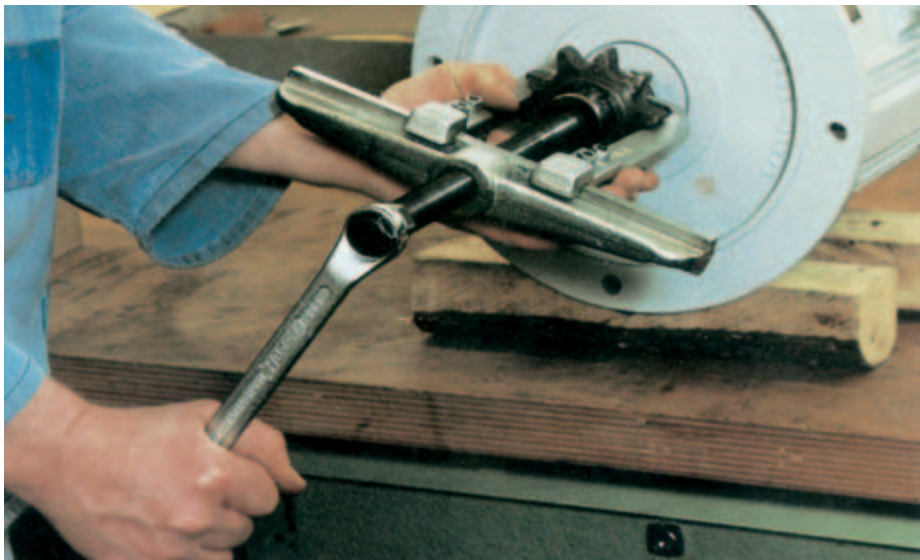
Bild 7-9: Ringschlüssel – hier zum Betätigen der Abziehvorrichtung – sind noch sicherer gegen Abrutschen als Maulschlüssel
