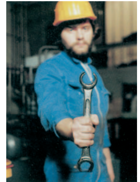
Bild 7-7: Auch hier ein Spezialwerkzeug? Ja, ein offener Ringschlüssel für Rohrverschraubungen
