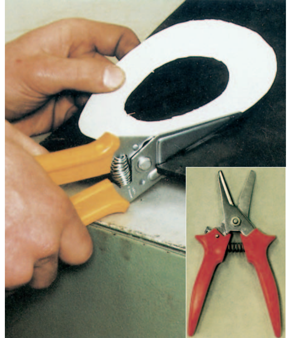
Bild 9-3: „Stumpfe“ Scheren mit abgerundeter Spitze und Zuhaltung verringern die Verletzungsgefahr und sind vielseitig zu verwenden
