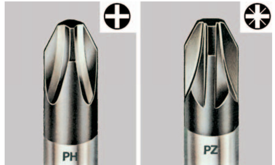
Bild 5-10: Kreuzschlitzklingen für PH-Phillips- bzw. PZ-Pozidrive-Schrauben, nicht nachschleifbar
