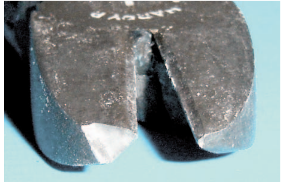
Bild 10-4: Zu hoher Härtewert der Schneiden führte zum Abruch der Spitze
