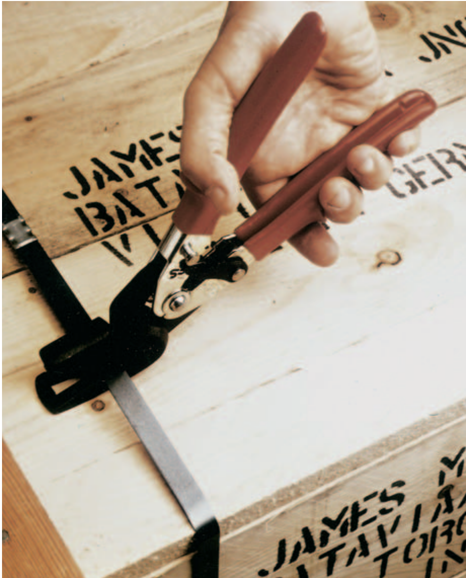
Bild 10-3: Für schwächere Bänder bis 0,6 mm Dicke existieren auch GS-geprüfte und mit nur einer Hand bedienbare Bandschneider mit Hebelübersetzung
