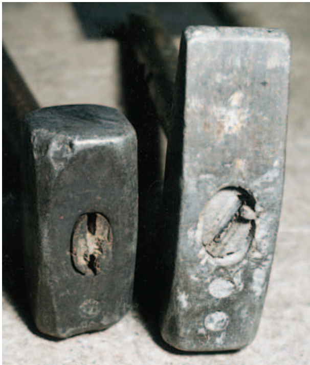
Bild 2-12: Unzureichender Kantenbruch sowie erhebliche Absplinterung durch Kantenschlag, außerdem: Fäustel links – fehlende Verkeilung des Stiels, Schlosserhammer rechts – loser, teils herausgezogener Stiel nach Austrocknung
