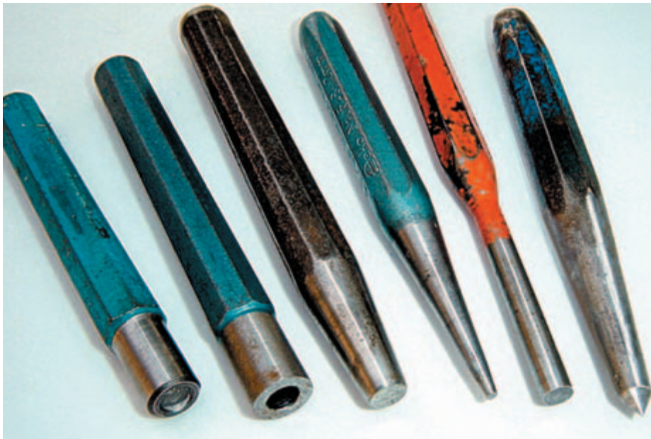
Bild 4-1: Von links nach rechts: Nietkopfmacher DIN 6534, Nietenzieher DIN 6534, Splinttreiber groß und klein, Durchschläge und Körner
