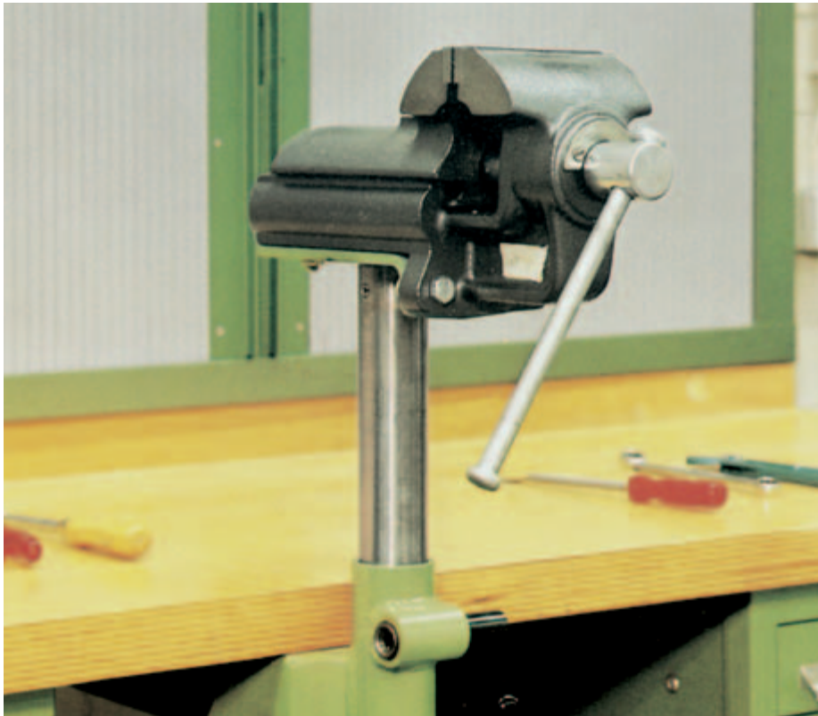
Bild 15-1: Parallelschraubstock – nach hinten öffnend – auf Höhenverstellgerät in oberer Position
