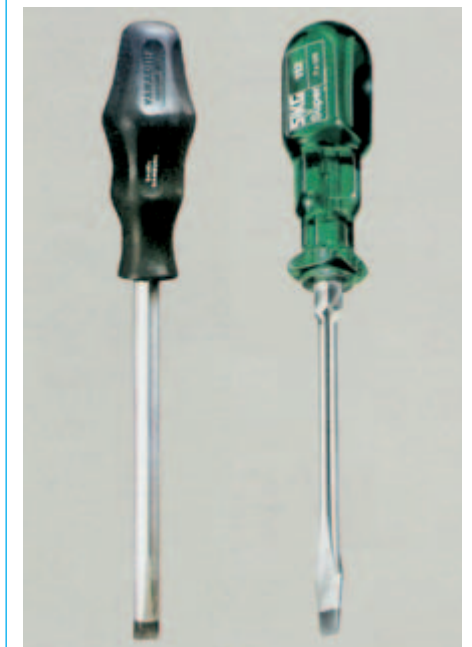
Bild 5-6: Griffe der Schraubendreher sind mehrkantig und ergonomisch der Form der Hand angepasst
