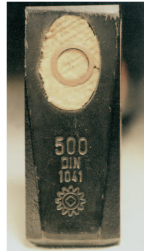
Bild 1-1: Kennzeichnung eines Hammers nach DIN. Von oben nach unten: Hammergewicht in Gramm, Nummer der Norm des Hammers und Herstellerkennzeichen
