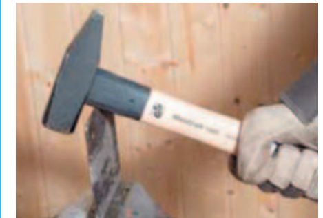
Bild 2-11: Entprellter Schlosserhammer mit Stielschutzhülse im Gummimantel
