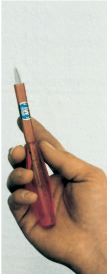
Bild 6-6: Die scharfen Kanten des Dreikant-schabers sind in Griffnähe ummantelt
