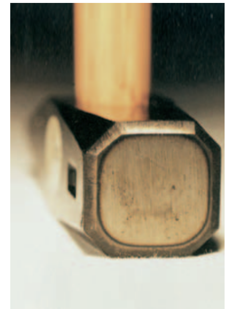
Bild 2-14: Hammerbahn mit induktiv angelassener Randzone und korrektem Kantenbruch
