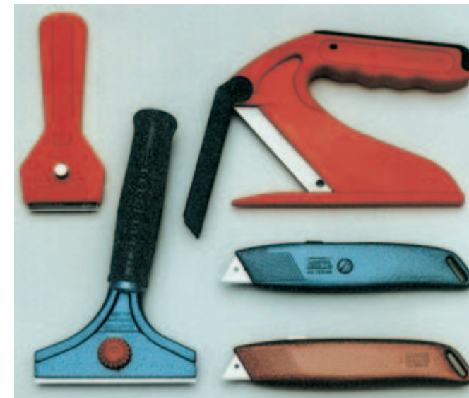
Bild 12-3: Klingengeräte mit rückziehbaren Klingen oder Klingendeckungen
