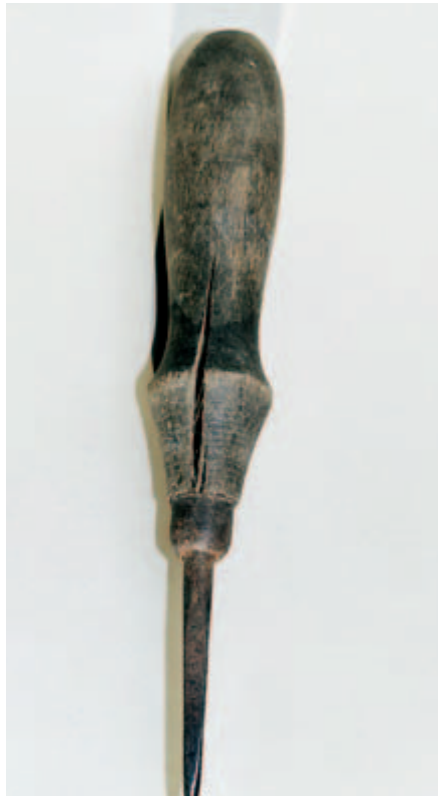
Bild 5-8: Gespaltene Holzgriffe lassen schnell eine Lockerung des Werkzeuges im Griff aufkommen und sind auszutauschen
