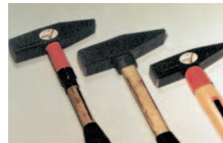
Bild 2-9: Schlosserhämmer mit Holz- bzw. Glasfaserstiel und Stielschutz
