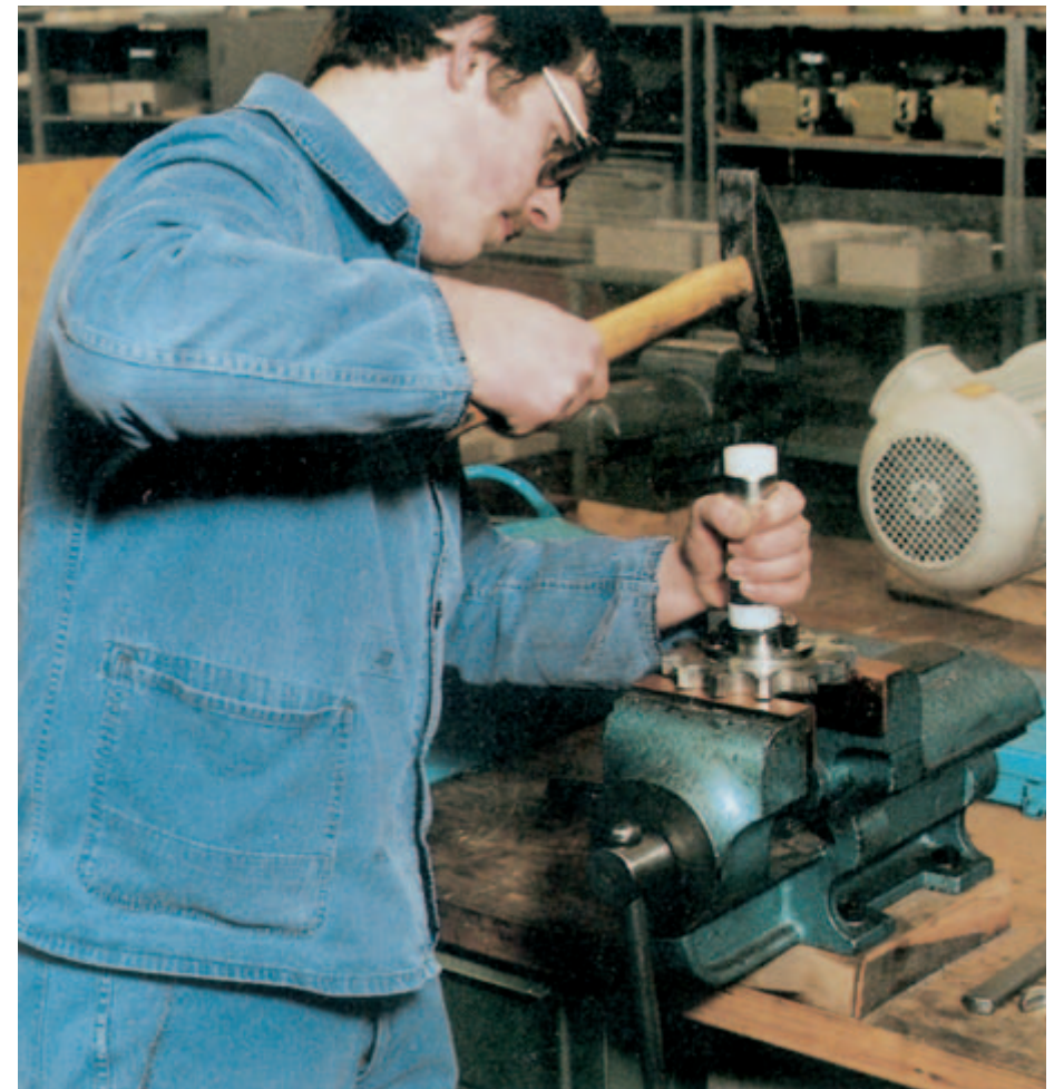
Bild 4-2: Rückschlagarm und schonend lässt sich mit diesem Dorn ein Lager treiben
