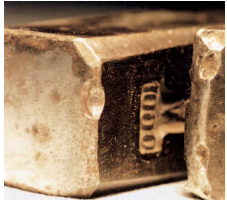
Bild 2-1: Ausscherungen von Stahlsplintern aus Hammerbahn und -pinne von Schlosserhämmern
