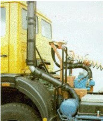
Abb. 27: Schutz gegen Berühren des Auspuffrohres
