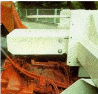
Abb. 26: Verdeckung der Kardanwelle
