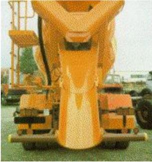
Abb. 24: Eingehängte Auslaufrutsche
