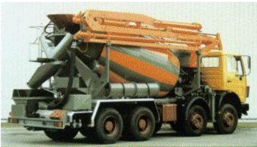
Abb. 30: Fahrmischer mit Betonpumpe
