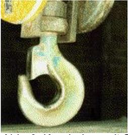
*Abb. 6: Kranhaken mit Sicherungsklappe*
