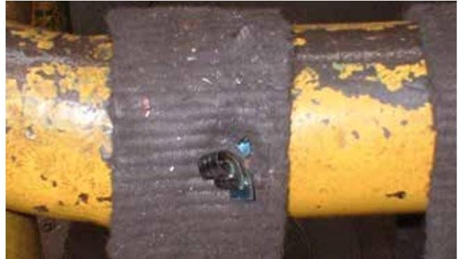
Bild 4-4: Durch heißen Span beschädigte Oberfläche
