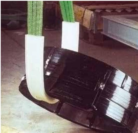
Bild 1-5: Kantenschutz - Schutzschlauch
