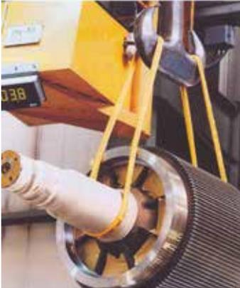
Bild 1-10: Sicherer Hängegang
