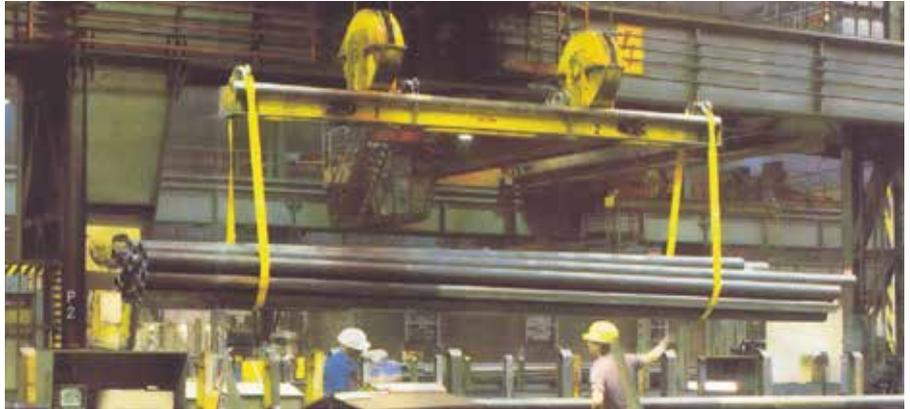
Bild 1-11: Sicheres Anschlagen langer Lasten
