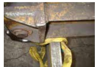
Bild 1-9: Beschädigung einer Rundschnle durch darauf abgesetzte Traverse
