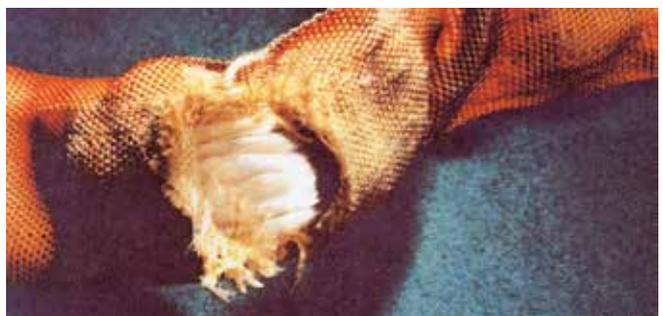
Bild 4-6: Beschädigung durch Hitzeeinwirkung
