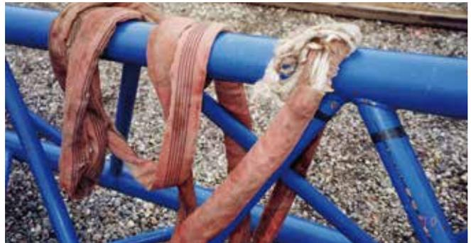
Bild 4-5: Starke Beschädigung der Ummantelung und der Einlage
