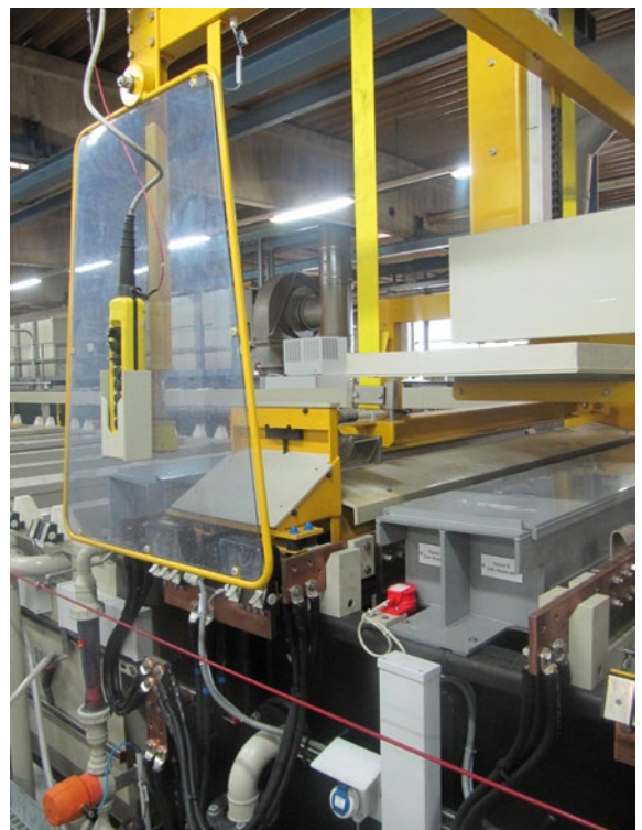
Abb. 2.8 Anfahrbügel mit Abdeckplatte am Transportwagen
