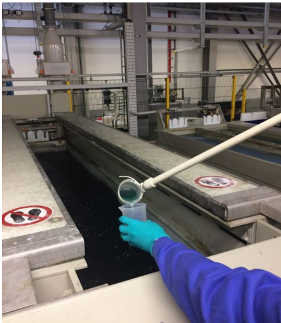
Abb. 8.1 Probeentnahme am Prozessbehälter mit geeignetem Hilfsmittel
