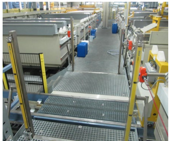
Abb. 2.6 Berührungslos wirkende Schutzeinrichtungen, z. B. zur Absicherung der Gefahrstellen an Querumsetzern von Galvanoautomaten
