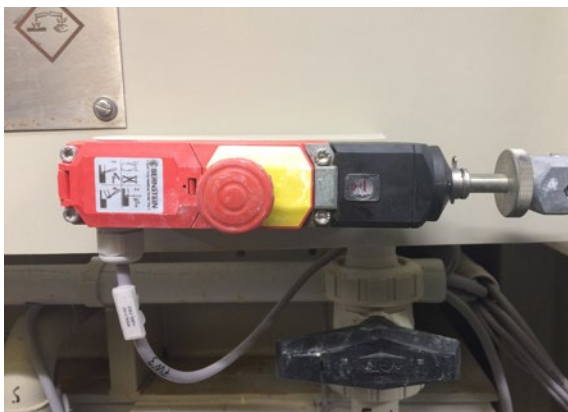
Abb. 2.7 Reißleine, mit Sicherheitseinrichtung gegen Schlaffseil
