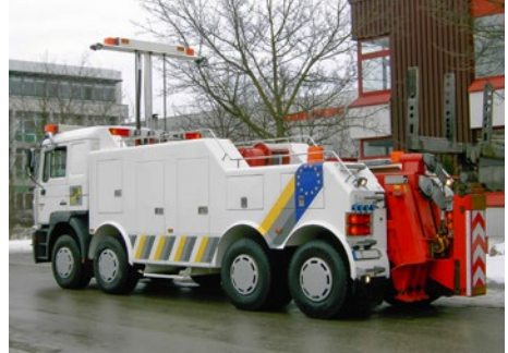
Abb. 2 Abschleppwagen (Unterfahrlift (AWU))
