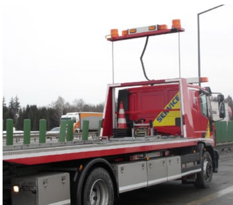
Abb. 7 Teleskopierbare, weit sichtbare Warnleuchten
