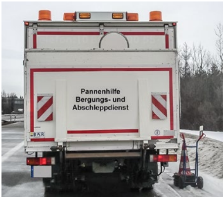
Abb. 8 Warnleuchten in Doppelblitztechnik
