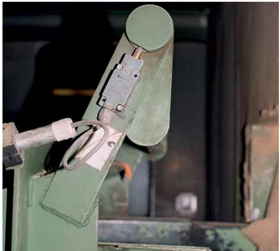
Bild 7: Schaltbügel vor der Einzugsvorrichtung des Hackers
