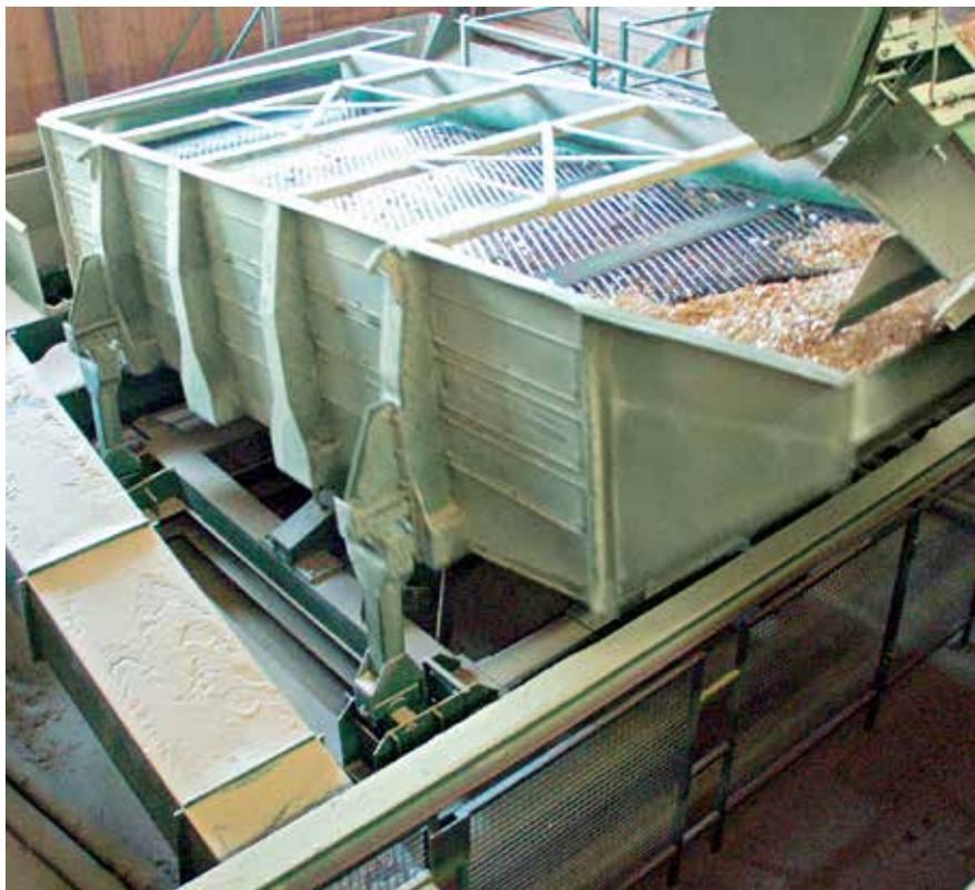
Bild 8: Schwingsieb mit Umzäunung
