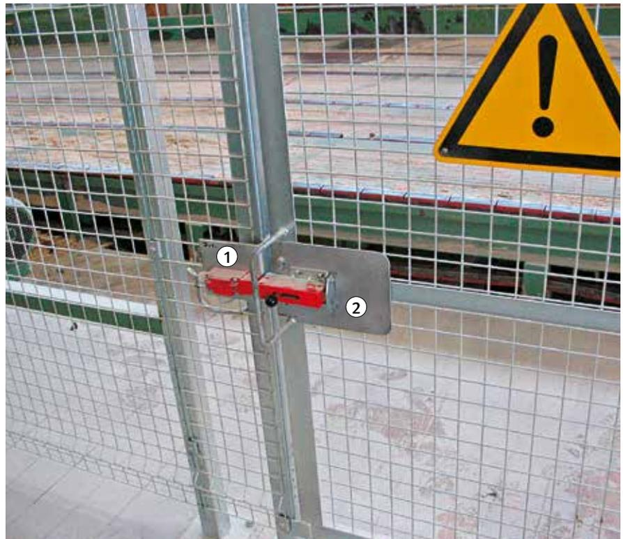
Bild 11: Elektrisch verriegelte Zugangstür
