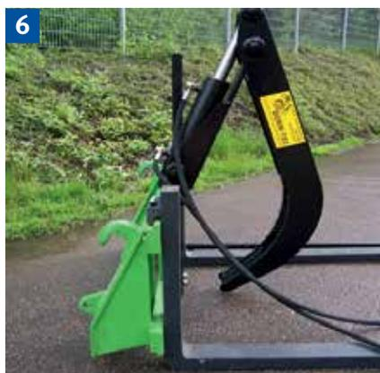
Gabelstapler mit Zangengreifer zum Transport von Rundholz.
