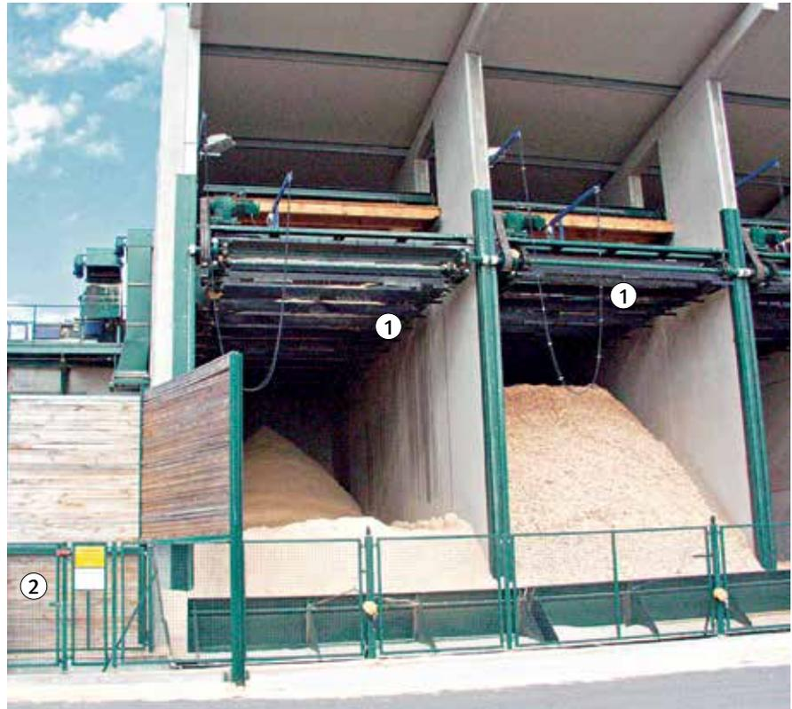
Bild 9: Späneboxen mit Egalisierereinrichtungen
