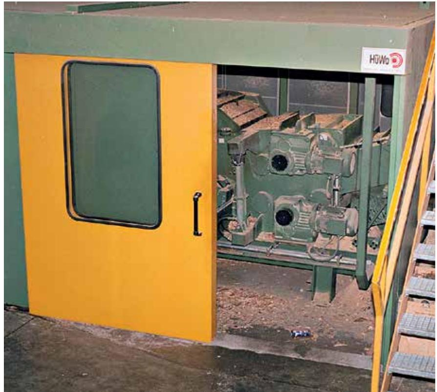
Bild 6: Hacker mit Schallschutzkabine
