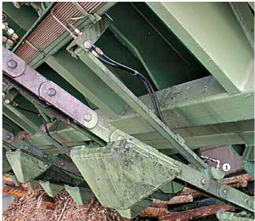
Bild 10: Zentralschmierung am rücklaufenden Kettenstrang eines Vereinzelners
