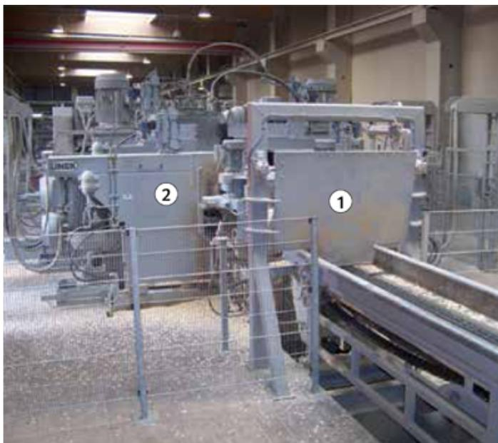
Bild 5: Eingeschwungene Rückschlagsicherung vor der Einzugs- und Zentriereinrichtung des Säge-Frässagregates (Quelle Linck)
