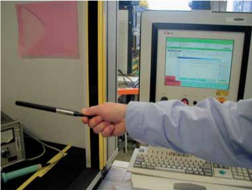
**Bild 2** Funktionskontrolle der Sicherheitslichtschranke mittels Prüfstab
