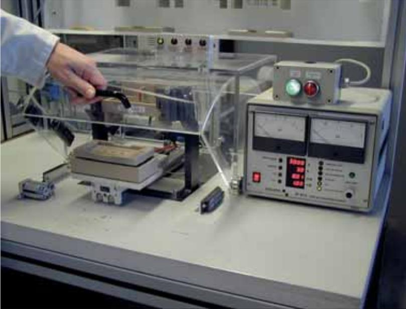
**Bild 3** Prüfplatz mit zwangsläufigem Berührungsschutz, vollständiger Berührungsschutz durch Gehäuse mit beweglicher Verdeckung, elektro-mechanische Verriegelung mit Stellungsüberwachung (hier: Endschalter mit Personenschutzfunktion)
