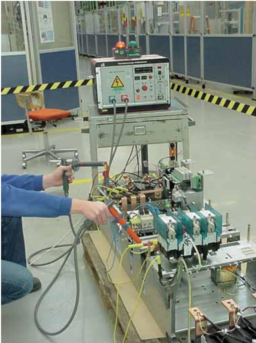
**Bild 6** Prüfarbeiten unter Verwendung von Sicherheitsprüfspitzen
