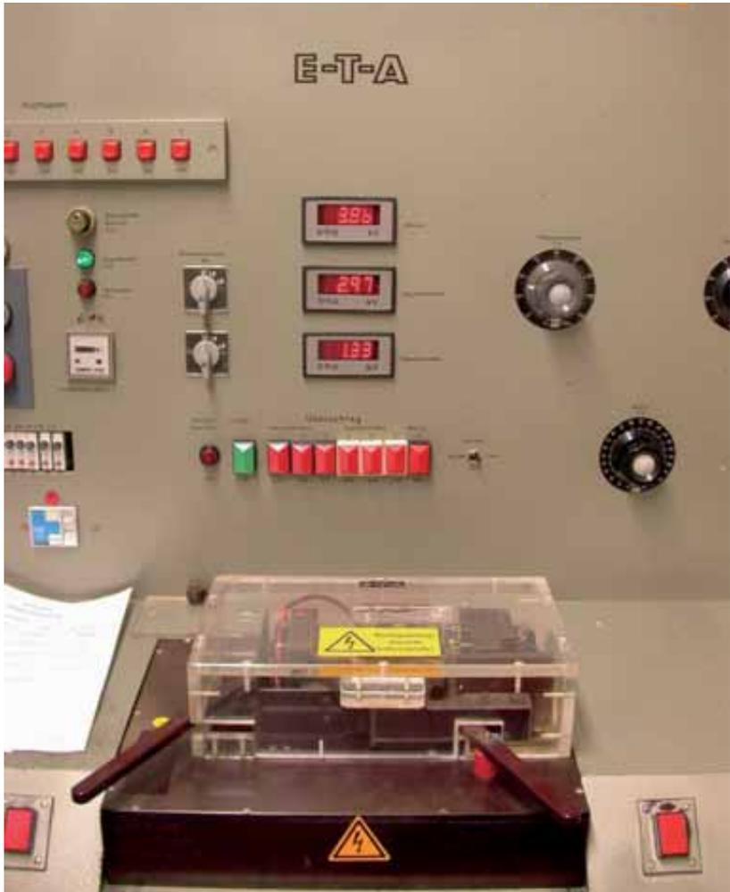
**Bild 4** Prüfplatz mit zwangsläufigem Berührungsschutz, mechanische Verriegelung der Schutzhaube. Der Handhebel, der die Haube in Schutzstellung mechanisch verriegelt, ist mit Schaltkontakten belegt, die in den EIN- und AUS-Schaltvorgang integriert sind.
