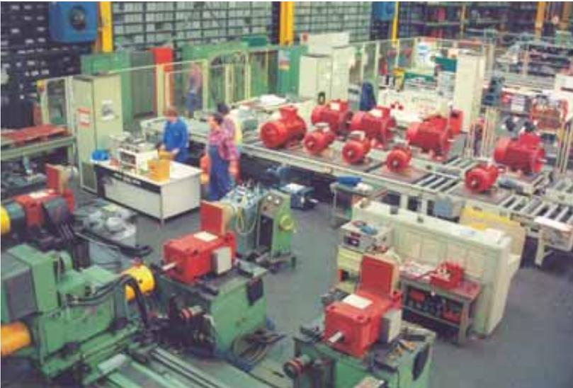
**Bild 7** Motorenprüffeld
