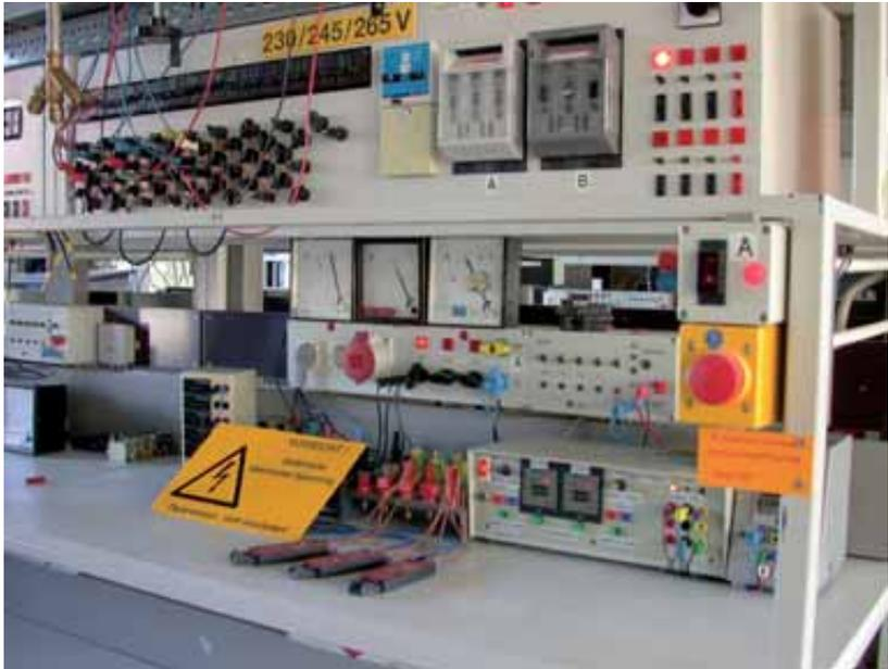
**Bild 10** Dauerversuch in abgeschlossenem Raum, das Prüffregal liegt seitlich zum Hauptverkehrsweg. Berührungsschutz ist ausreichend, zufälliges oder unbeabsichtigtes Berühren ist durch Anordnung und Wahl der Anschlussmittel verhindert.
