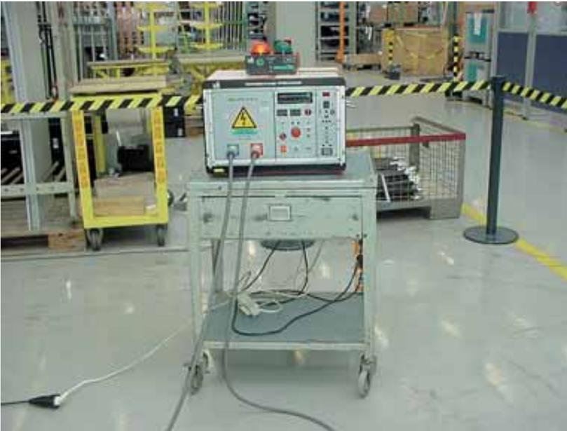
**Bild 5** Durch Ausziehband abgegrenzter Prüfbereich für einen Prüfplatz ohne zwangsläufigen Berührungsschutz
