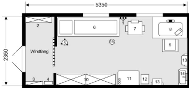
Grundriss eines Sanitätscontainers
