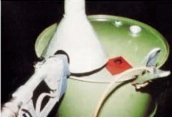
Bild 21: Absaugung an einer Fassabfüllung für gesundheitsgefährdende Flüssigkeiten
