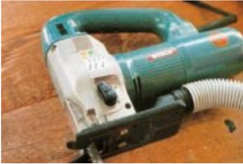
Bild 22: Abgesaugte Stichsäge zur Holzbearbeitung
