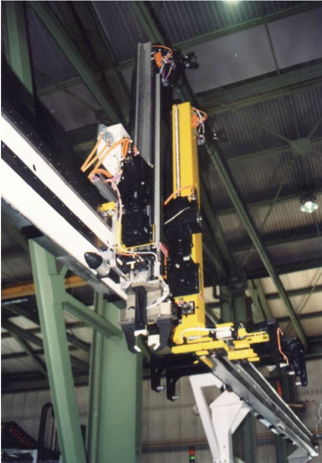
Abb. 57 Schwerkraftbelastete Achse [H]
