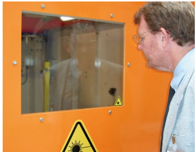
Abb. 45 Sichtfenster an einer Laserschweißanlage [H]
