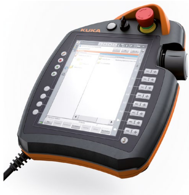
Abb. 27 Betriebsartenwahlschalter auf Programmierhandgerät [A]
