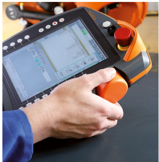
Abb. 33 Programmierhandgerät (PHG) mit Not-Halt-Taster [H]
