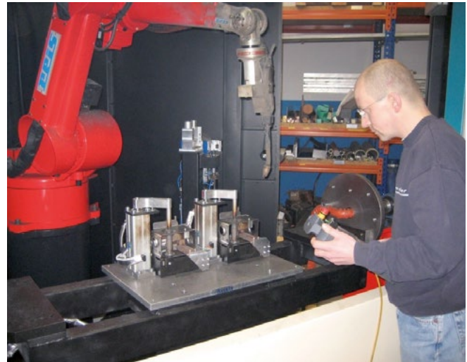
Abb. 28 Betätigung des Zustimmungsschalters beim Programmieren [F]
