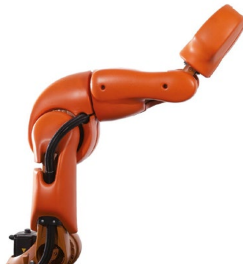
Abb. 51 Roboter mit taktilen Schutzeinrichtungen [L]
