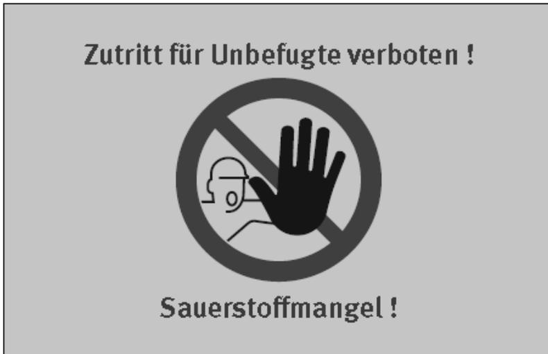
**Abb. 3** Beispiel einer Kennzeichnung am Zugang zu einem sauerstoffreduzierten Bereich im Alarmfall – Leuchttabelleau
