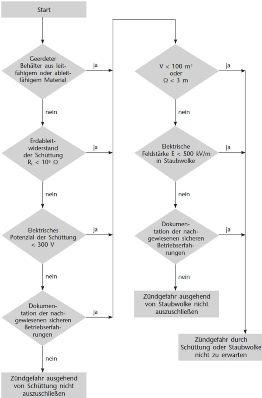
2.10 Ablaufdiagramm 1: Beurteilung der Zündgefahr ausgehend von Schüttgütern mit einem spezifischen Widerstand  $p \leq 10 \Omega \cdot m$  – Seite 2 – 01.09.2014
