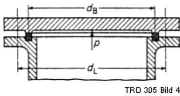
**Bild 5.** Eingeschweißte Platten
