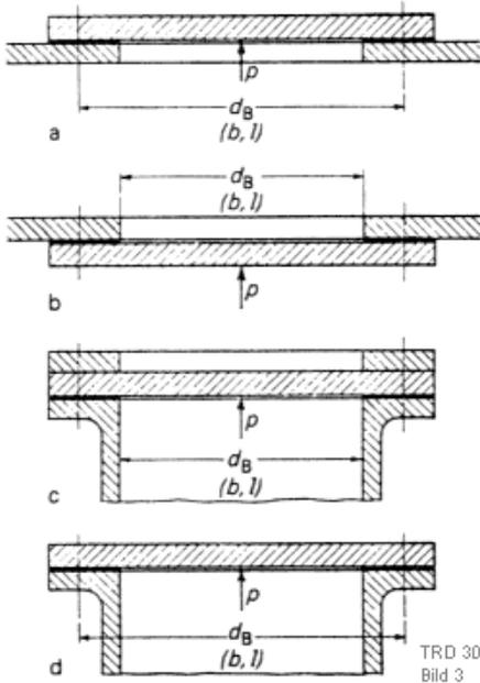
**Bild 4.** Verschraubte Platte mit zusätzlichem Biegemoment
