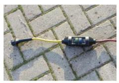
Abb. 5-3 Portabler Fehlerstromschutzschalter (PRCD) – Beispiel
