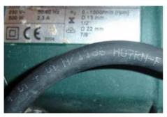
Abb. 5-2 Gummischlauchleitung
