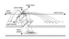
**Abb. 5-5** Ausbreitungsverhalten heißer Partikel beim Schweißen
