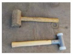
Abb. 2-1 Lederhammer und rückschlagfreier Hammer
