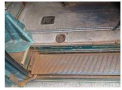
Abb. 9-2 Belüftungsöffnung im Fahrzeugboden
