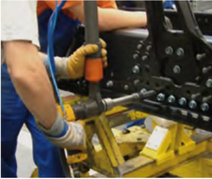
Bild 6-5: Ersatz von Schlagschraubern durch Drehmomentschrauber. Die Benutzung von Gehörschutz ist nicht notwendig. Balancer verbessern die Ergonomie
