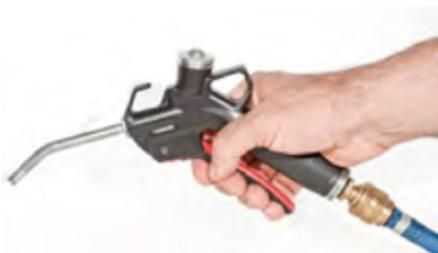
Bild 6-3: Lärmgeminderte Druckluftdüse
