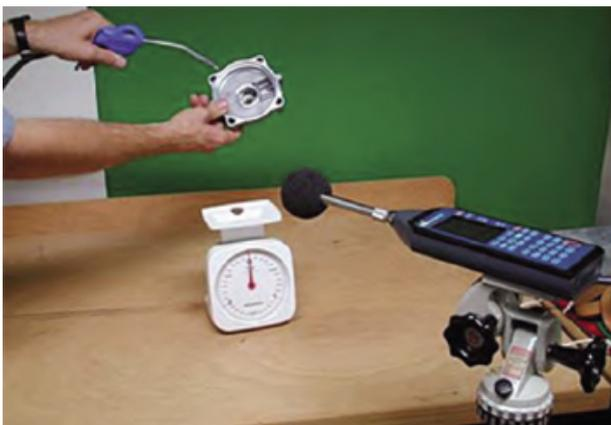
**Bild 6-7:** Lärm- und Kraftmessung an Druckluftdüsen
