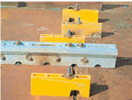
Bild 6-4: Bolzenschweißen bei der Plattenstoßmontage im Schiffbau. Dieses Verfahren ersetzt das Anschweißen von z. B. Knacken, die später mit erheblichem Lärm abgetrennt werden müssen. Senkung des Tages-Lärmexpositionspegels um ca. 10 dB(A)
