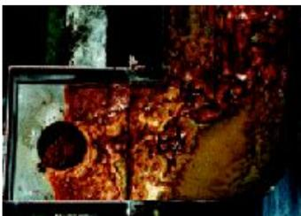
Bild 5-3: Biofilm auf einem wassergemischten Kühlschmierstoff
