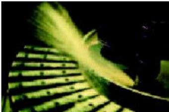
Bild 5-2: Schleifen von Wälzlagerrollen
