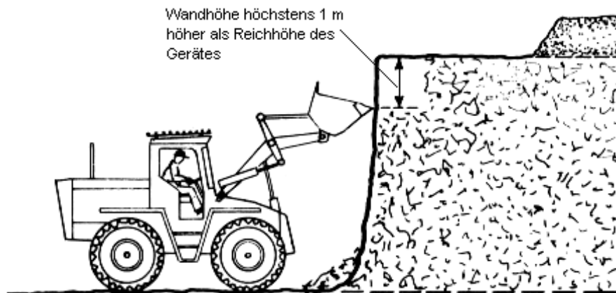
Bild 10: Gewinnung mit Schaufellader
