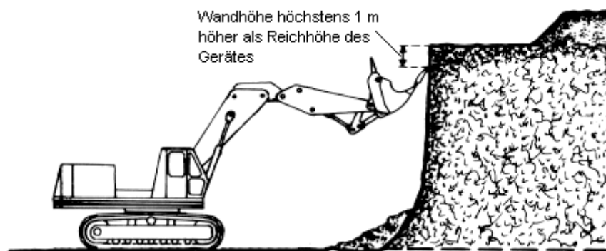
Bild 11: Gewinnung mit Hochlöffelbagger
