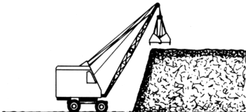
Bild 9: Gewinnung mit Greifbagger im Hochschnitt
