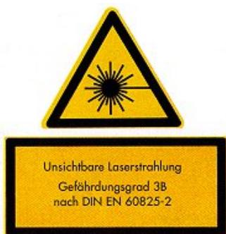
Bild 8: Sicherheitskennzeichnung der Arbeitsbereiche je nach Gefährdungsgrad und Zugang
