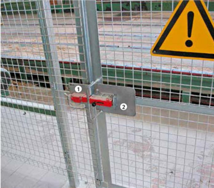
Bild 42: Elektrisch verriegelte Zugangstür
