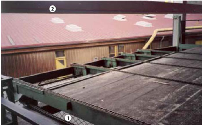
Bild 45: Absturzsicherung an erhöhten Stapelbereichen
