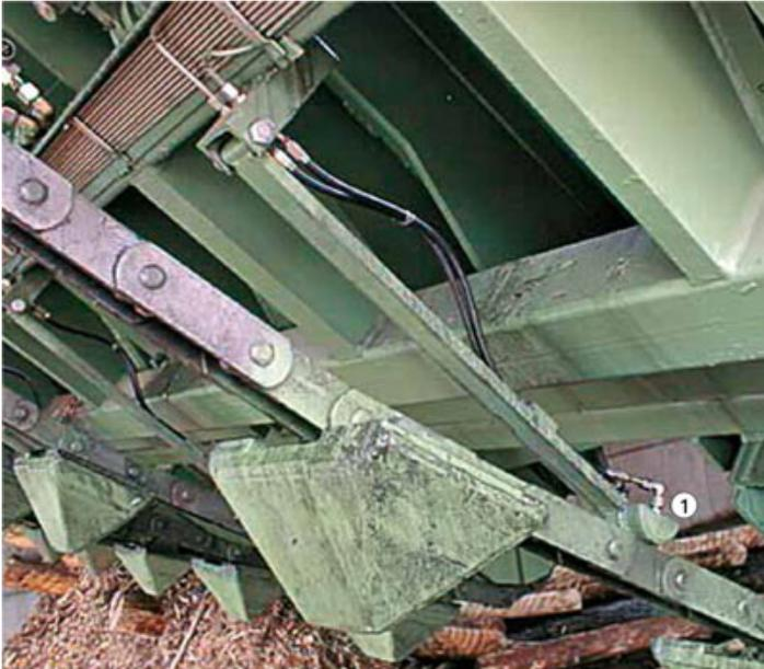
Bild 41: Zentralschmierung am rücklaufenden Kettenstrang eines Vereinzelers
