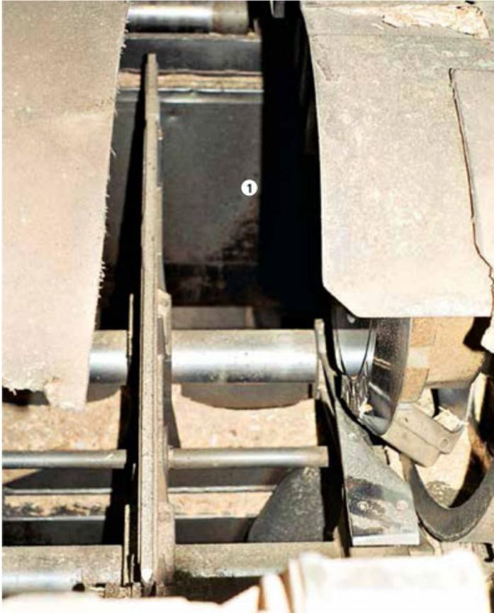
Bild 47: Fehlende Standfläche zum Werkzeugwechsel an einem Spaner
