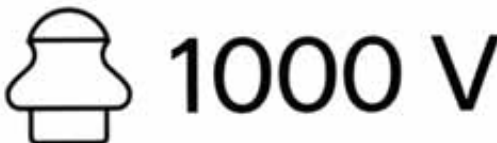
Bild 7: Kennzeichnung von elektrisch isolierenden Schuhen für Arbeiten an Niederspannungsanlagen
