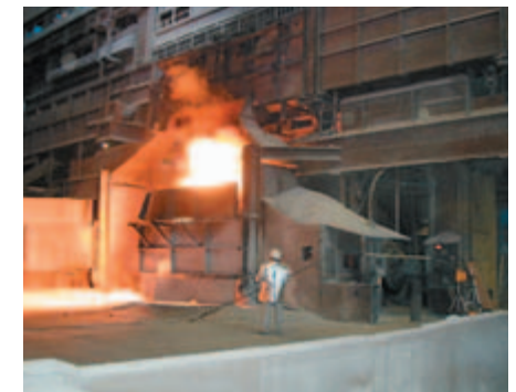
Bild 5-6: LD-Konverter während des Frischprozesses
